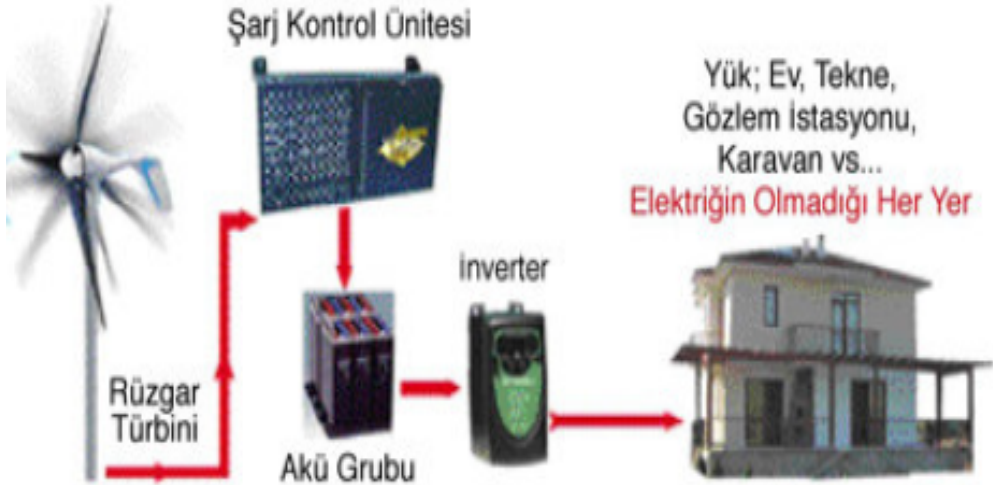
Şekil No 15: Şebeke Bağlantısız Rüzgar Enerji Sistemi
