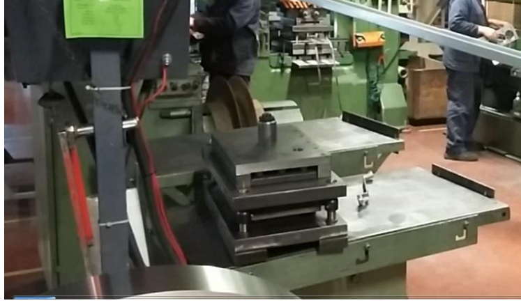
Şekil 5.19. Kalıp taşımaların dışsal faaliyete dönüştürülmesi
