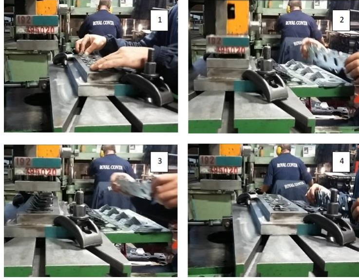
Şekil 5.38. Güvenlik amaçlı geliştirilen sürgülü tabla
