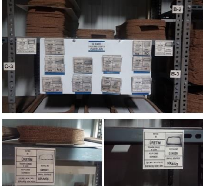
Şekil 5.11. Mantar contalar için çekmeyi sağlayan kanbanlar
