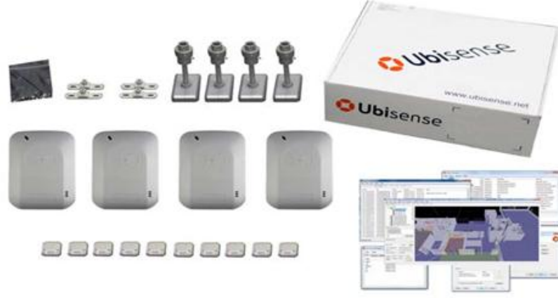
Şekil 3. Ubisense konum belirleme sistemi
