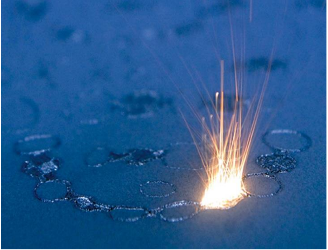
Şekil 9.3. Sinterlemenin lazer yoluyla yapıldığı an
