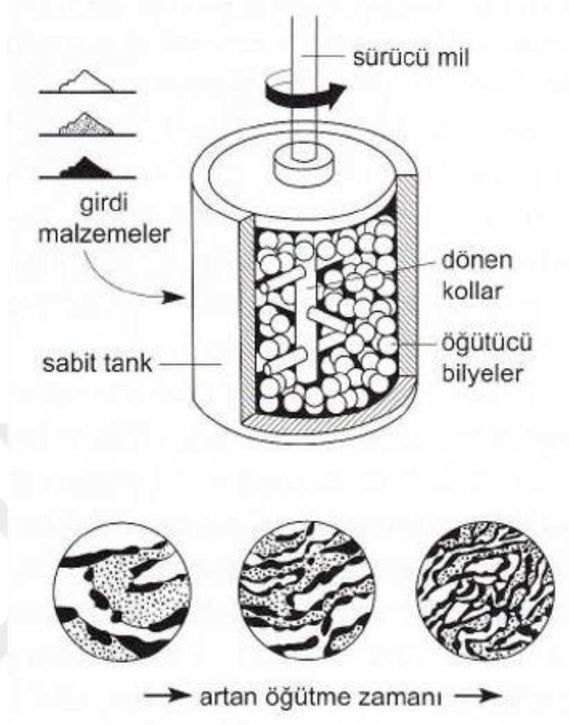
Şekil 6.4. Mekanik alaşımlamanın şematik gösterimi (Cerit, 2014)
