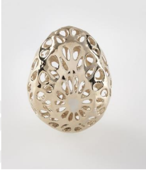
Şekil 9.14. Lazer sinterleme ile yapılmış içi boş ajurlu modelin bitmiş cilalı hali
