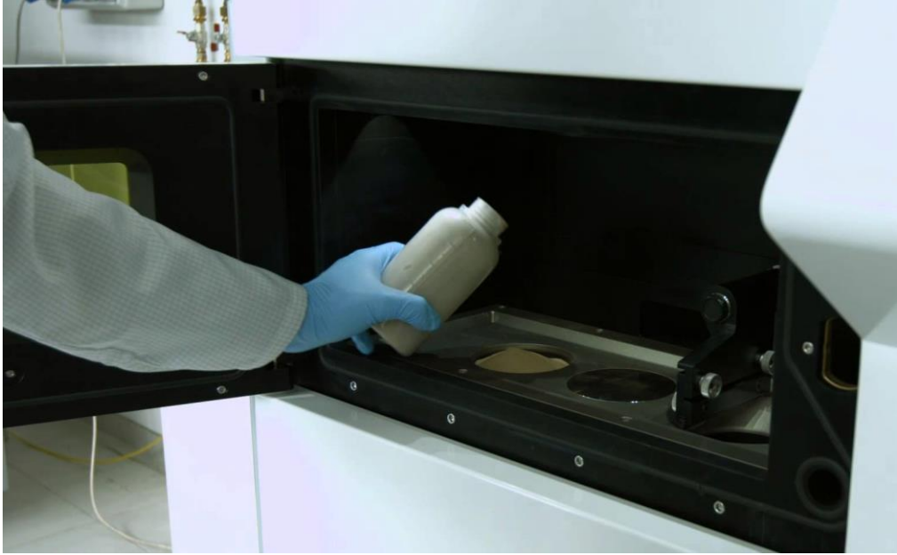
Şekil 9.6. Lazer sinterleme yapılan makinenin haznesine uygun toz alaşımının koyulma işlemi
