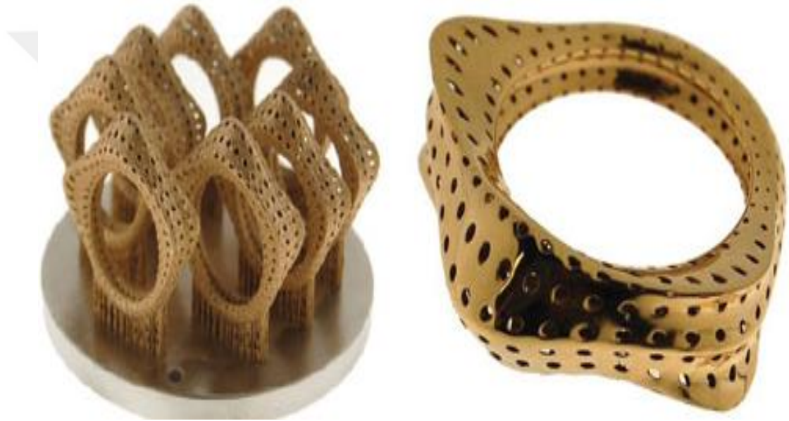
Şekil 9.5. Lazer sinterleme sonunda makineden çıkarılmış yüzük örneği (Sisma, 2017)
