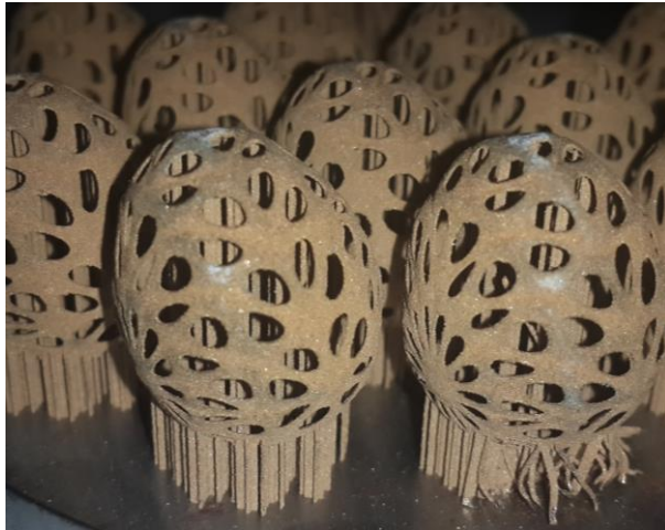
Şekil 9.7. Lazer sinterlemesi yapılan bronz takının supportlarının dizilimi
