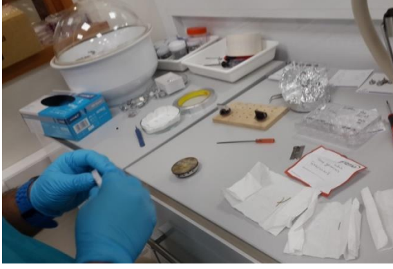
Şekil 8.8. SEM’de analizi yapılacak numelerin hazırlık aşaması
