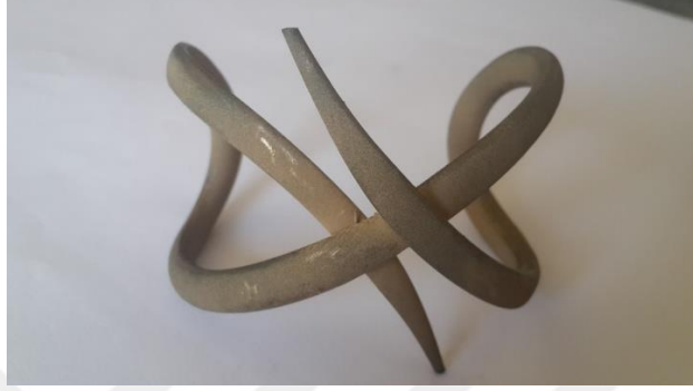
Şekil 9.11. Lazer sinterleme yolu ile üretilmiş üzerinde başka işlem görmemiş tek büyük bir bilezik örneği
