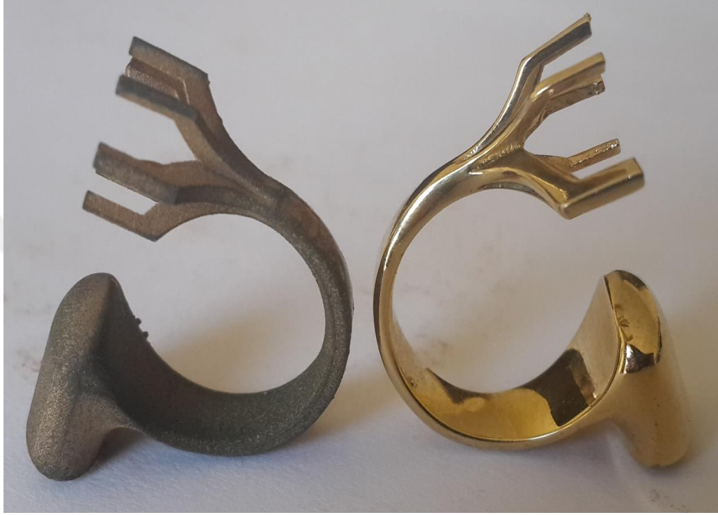
Şekil 9.10. Lazer sinterleme yoluyla üretilmiş olan aynı şekildeki yüzüğün sinterlemeden sonra işlem görmemiş ve oksitlenmiş hali ile zımpara ve cilası yapıldıktan sonra altın kaplama ile kaplanmış hali
