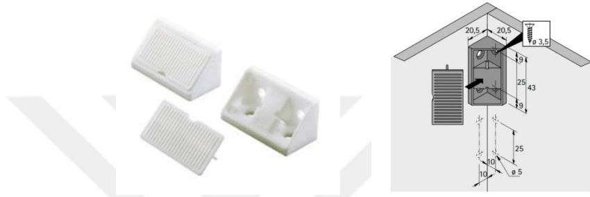
Şekil 3.18. Hettich, Ünlversal köşe birleřtiricisi ve montaj şeması (Hettich, 2014)
