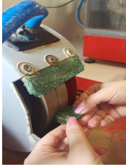
Şekil 4.36. Aşındırma makinesi ile pre-form işlemi (sağ).
