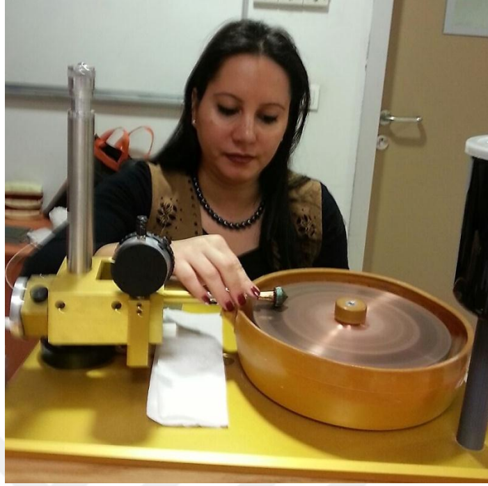
Şekil 4.42. Aşındırıcı 600 nolu lapta kesim işlemi.
