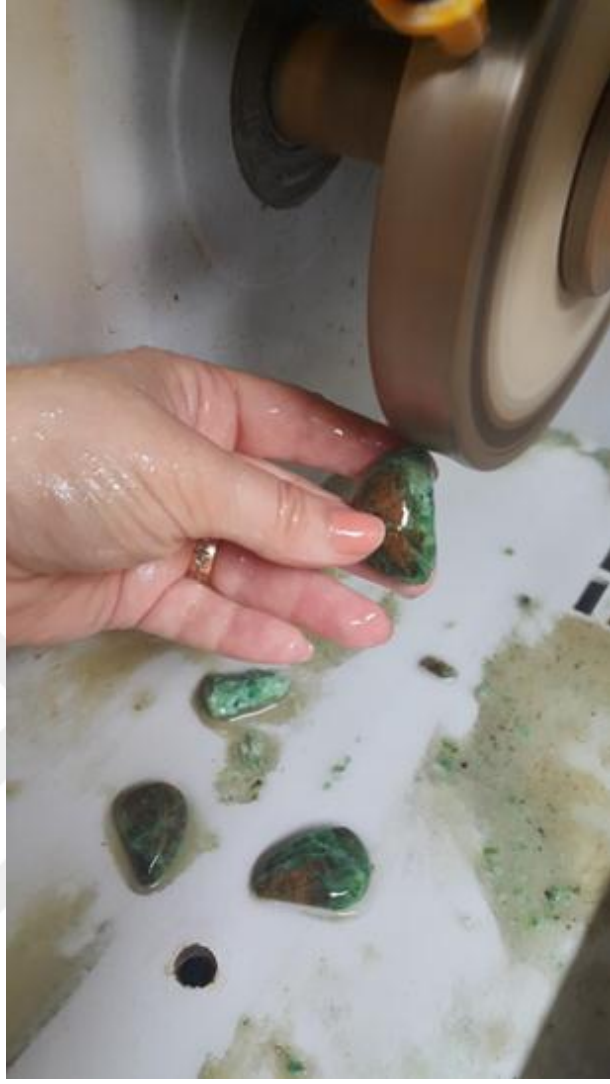
Şekil 4.46. Aşındırarak pre-form işlemi.
