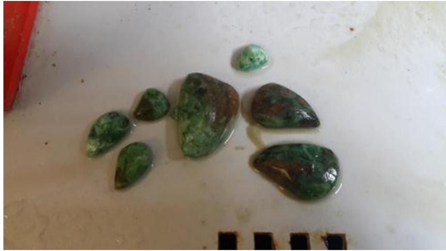
Şekil 4.47. Aşındırarak pre-form işlemi.
