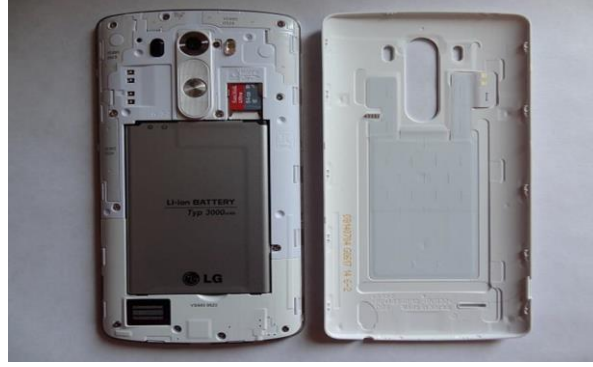
Şekil 4.4. Bir mobil cihazın NFC anteni (NFC World, 2016)
