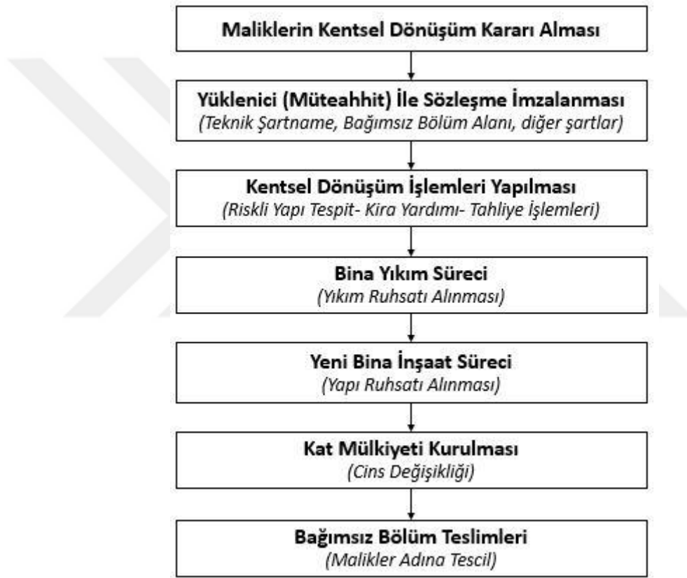
Şekil 5. 6. Kentsel Dönüşüm Süreci Şeması (Çalışma kapsamında geliştirilmiştir.)
