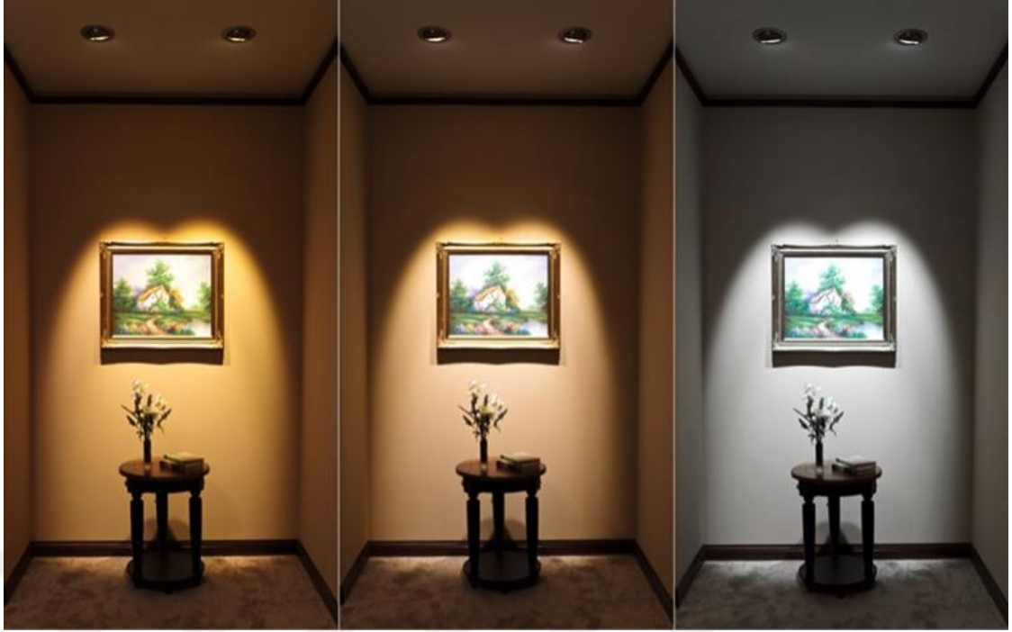
Şekil 3.5. Işığın renk sıcaklığına örnekler
