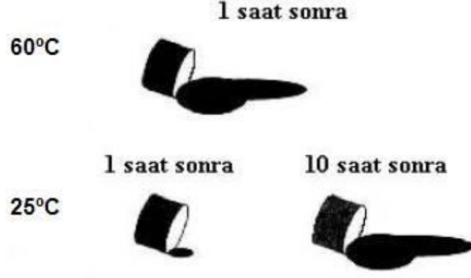
Şekil 3.5. Bitümün farklı sıcaklıklardaki davranışı (Hacıoğlu, 2013)
