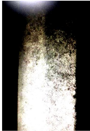
Şekil 6.11. MA+TMA numunelerinde oluşan kılcal çatlaklar görüntüleri
