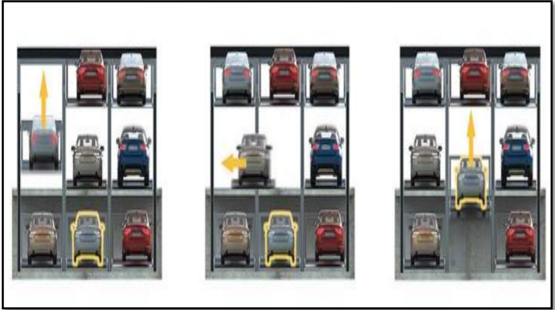
Şekil 3.9. Yarı otomatik otopark sistemi çalışma şeması (Otomatik, 2019)
