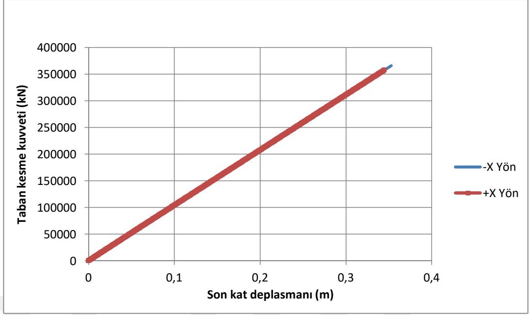
Şekil 9.9. 8 m Genişlikli Perdede Sistemin –X ve +X Yönündeki Kapasite Eğrisi
