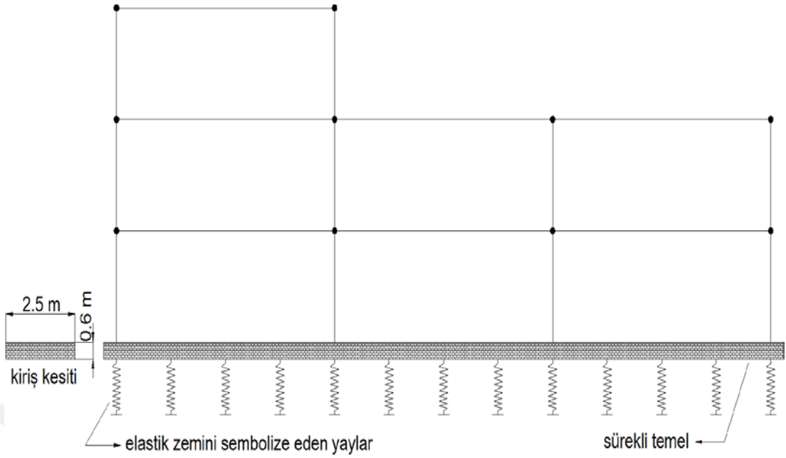
Şekil 3.3. Eksenel Rijitliği Olan Yaylarla Tanımlanmış Zemini Tarif Eden Sistem
