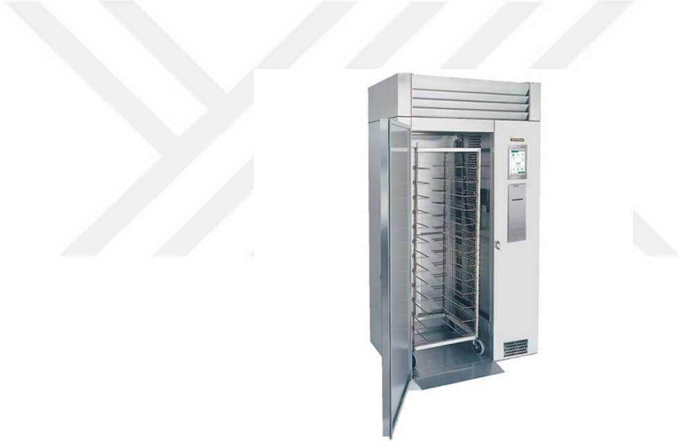
Şekil 60: Blast chiller: Sıcak Ürünleri Bakteri Oluşmadan Soğutmayı ya da Dondurmayı Sağlar(89x137cm H:241cm) (URL-42)
