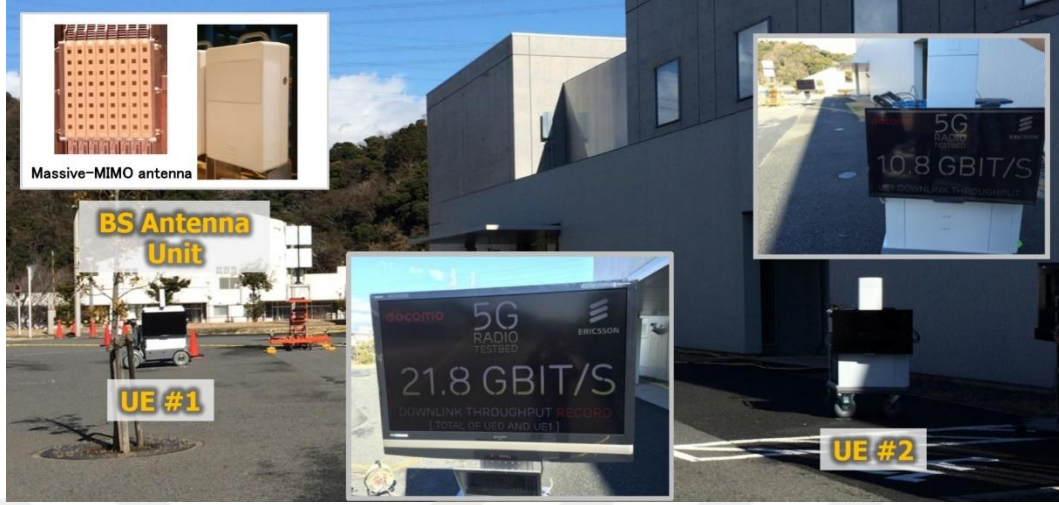
Şekil 19 Beşinci Nesil Ericsson'un 15 GHz'lik MU-MIMO Deneyi
