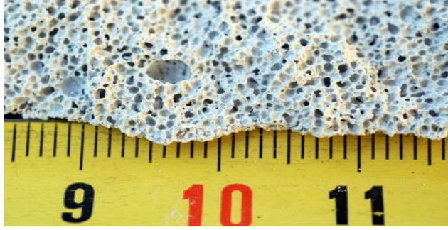
Şekil 2.13: Gazlı Otoklavlı Beton - yakından görünümü [Url-11]
