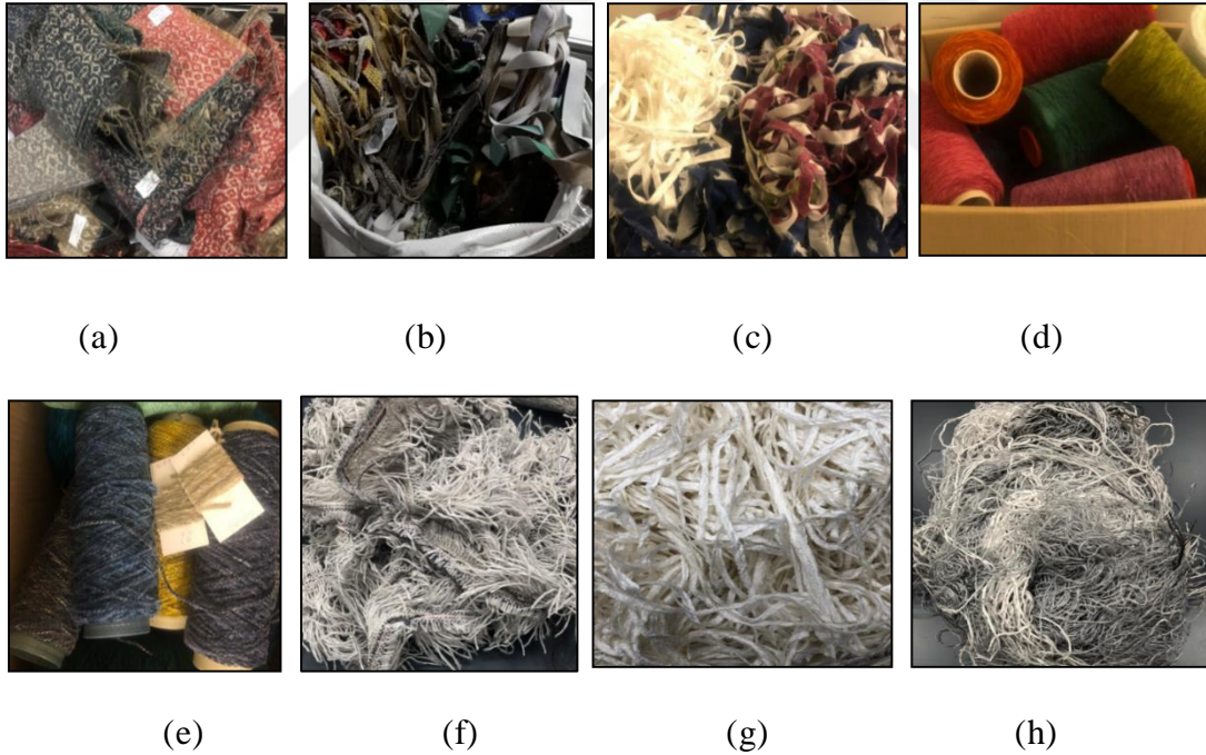
Şekil 10: Tekstil Üretim Atıkları; a) Şablon dokuma kumaş atıkları, b) Kumaş atıkları, c) Örne kenar üstübü, d) Bobin atıkları, e) Deneme bobinleri, f) Dokuma kenar üstübü, g) Şönil iplik üstübü, h) Polip iplik üstübü (Zeynep Özdem).
