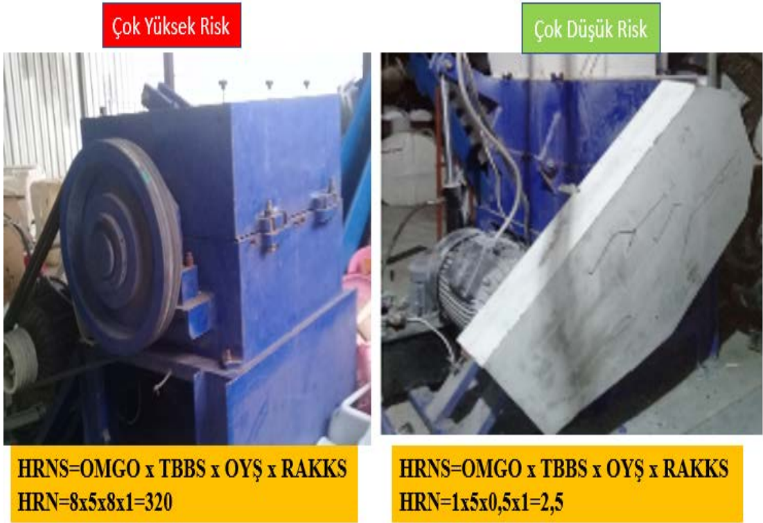
Şekil 4.6: Plastik kırma makinesi korumalı ve korumasız hali
