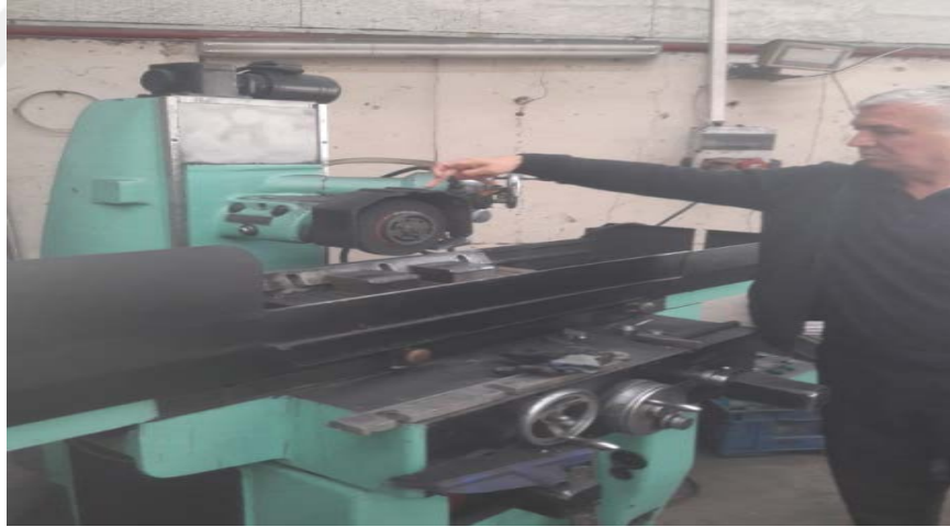
Şekil 2.45: Üniversal satıh taslama ile kırma bıçağı bilemesi
