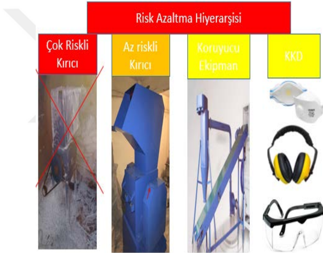
Şekil 4.4: Korumasız kırıcının risk azaltma hiyerarşisi
