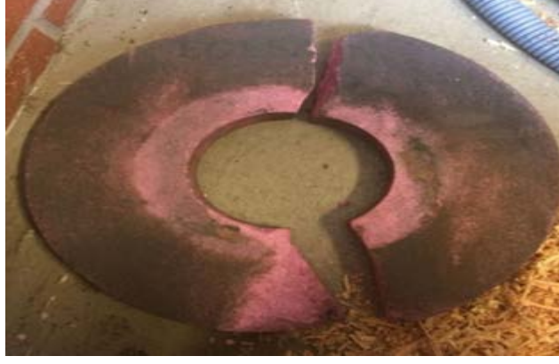
Şekil 2.44: Kırılmış bıçak bileme taşı
