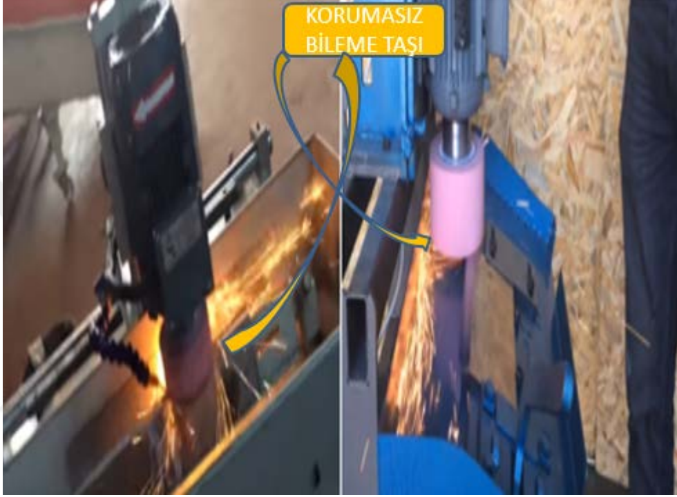
Şekil 2.43: Kıırma bıçağı bilemesi
