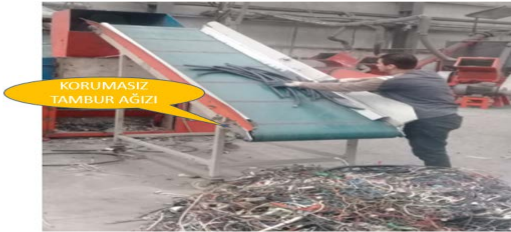
Şekil 2.11: Aktarma organın korumasız çalıştırılması
