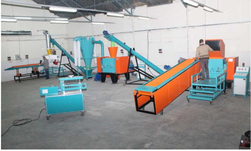
Şekil 2.2: Atık bakır kablo kırma ve ayrıştırma prosesleri
