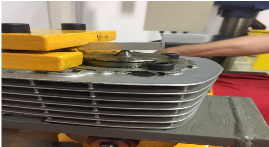
Şekil 4.4: Deney parçamız makinede tekrarlı yüke tabi tutulurken
