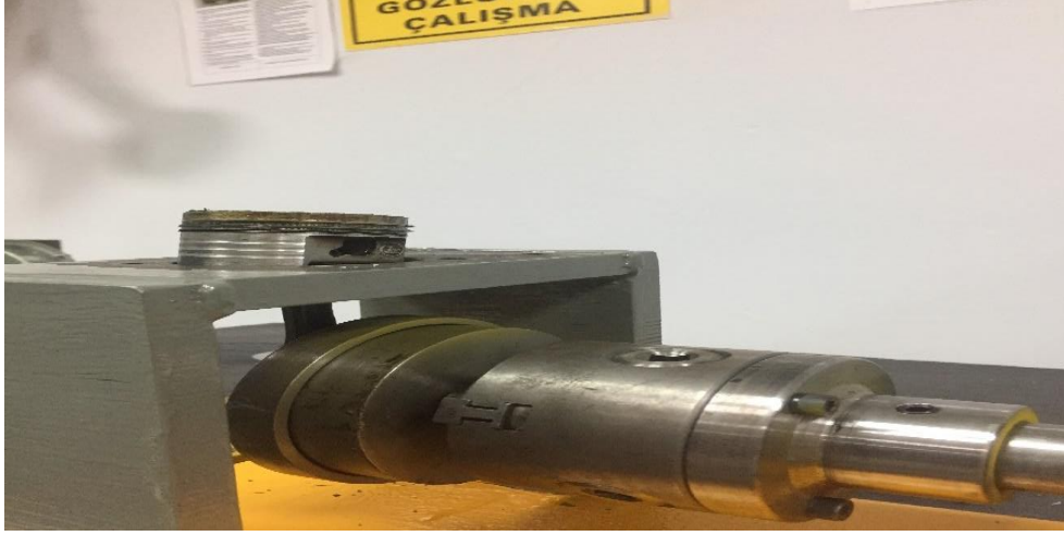
Şekil 3.7: Biyel kolu-Piston bağlantısı
