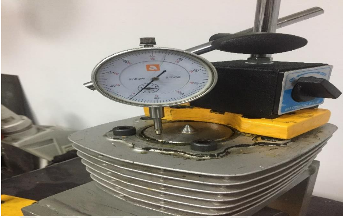
Şekil 3.10: Strok ayarının ölçümü
