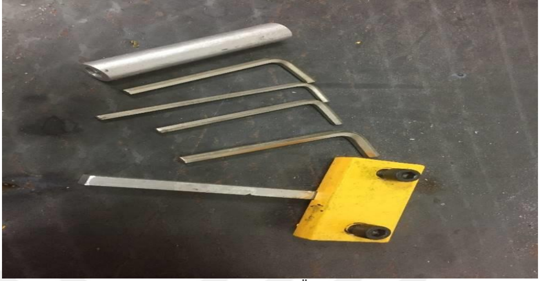
Şekil 3.13: Deneş Kalıbının Üst Sabitleme Parça
