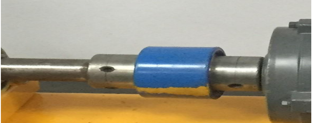
Şekil 3.3: Yorulma makinesi kavrama elemanı
