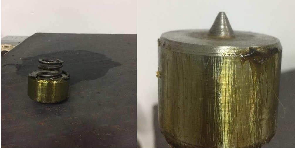
Şekil 3.9: Numuneye kuvvet uygulayan kapak ve Yay
