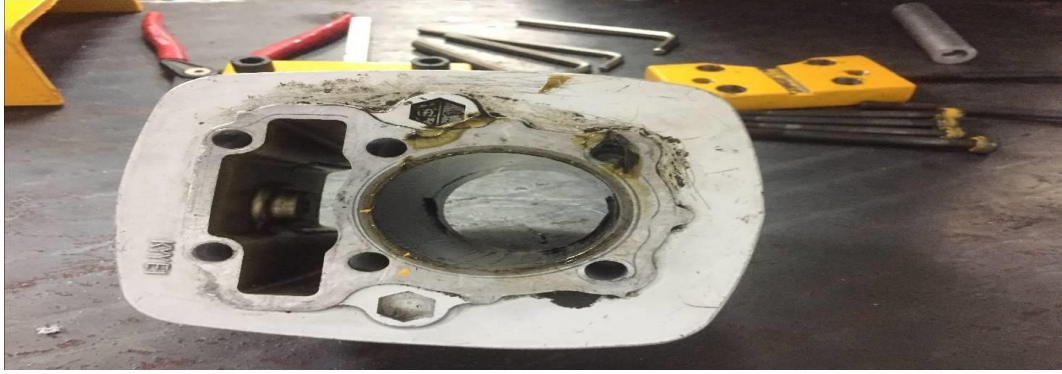
Şekil 3.8: Makinede kullanılan 125cm 3 'lük motor bloğu
