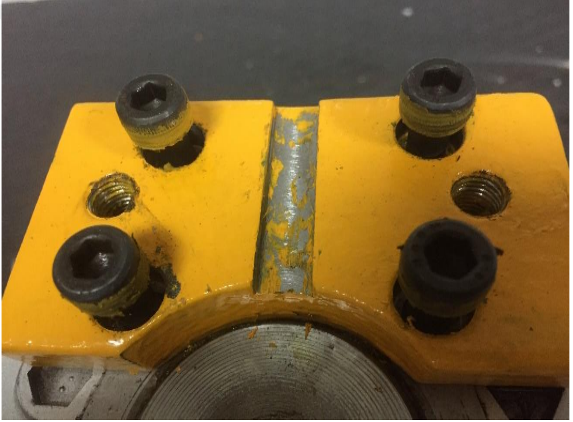
Şekil 3.12: Deney Kalıbının Alt Sabitleme Parçası
