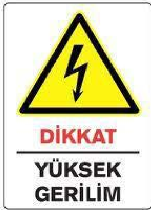
Şekil 6.8: Yüksek Gerilim İkaz Levhası
