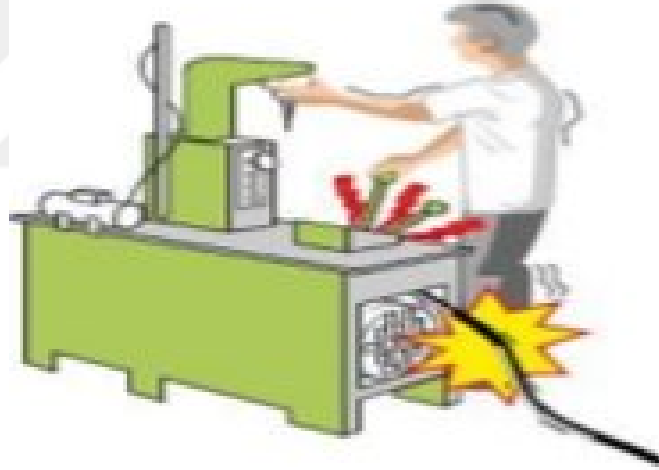
Şekil 4.3: Elektrikle Dolaylı Temas
