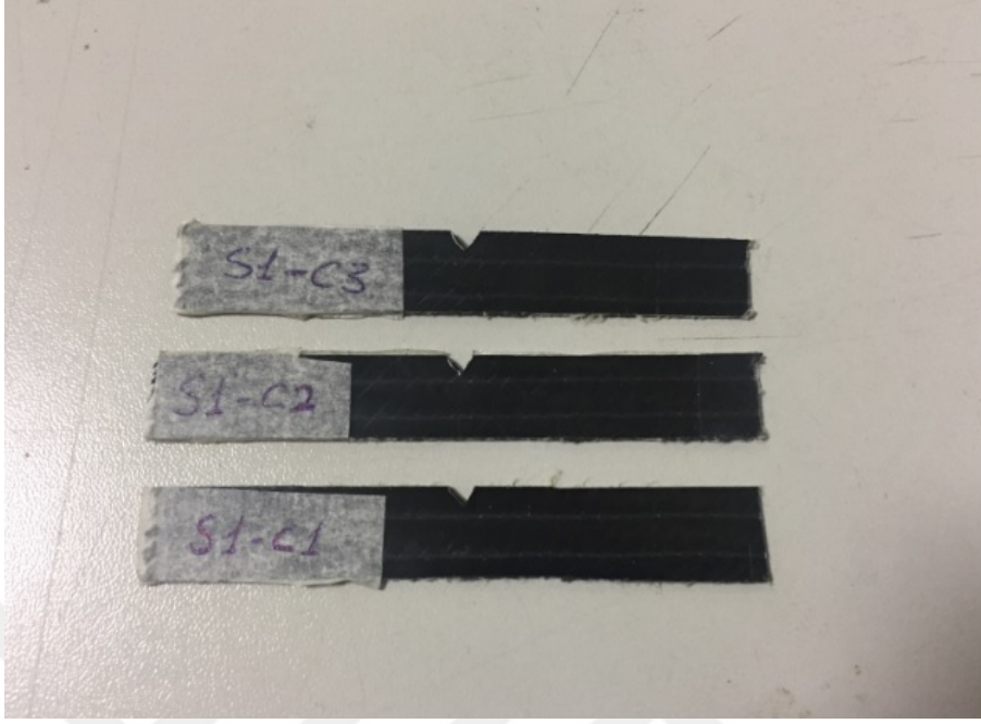
Şekil 6.11: Çentik darbe deneyi numuneleri
