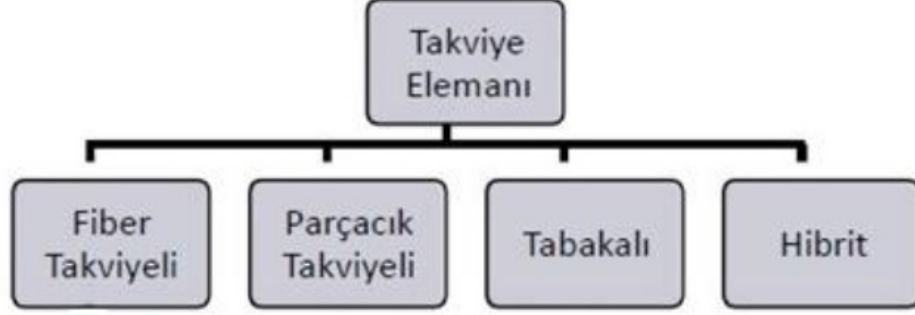
Şekil 2.9: Kompozitlerin takviye fazına göre sınıflandırılması
