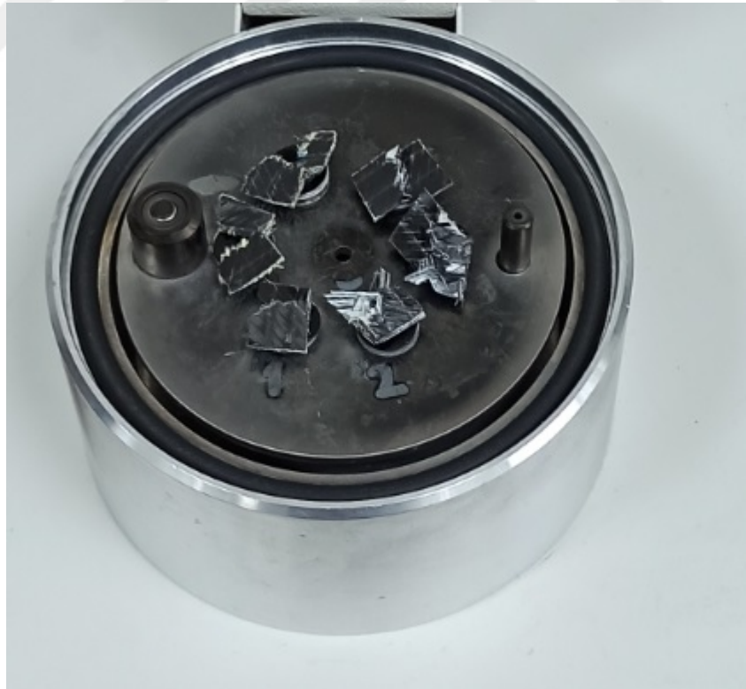
Şekil 6.20: Au – Pd ile kaplanmış numuneler
