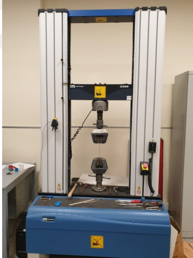
Şekil 5.6: Instron 3382 çekme testi cihazı
