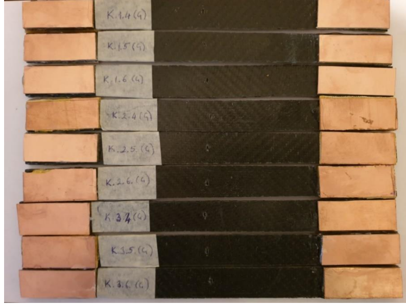
Şekil 5.5: Yüzey çatlaklı çekme testi numuneleri
