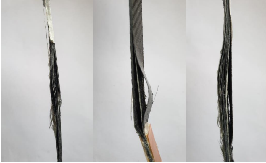
Şekil 5.12: Numunelerde meydana gelen hasar modları
