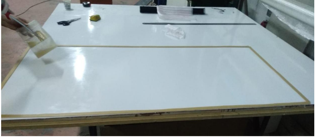
Şekil 4.1: Çerçevenin oluşturulması ve vakslama işlemi
