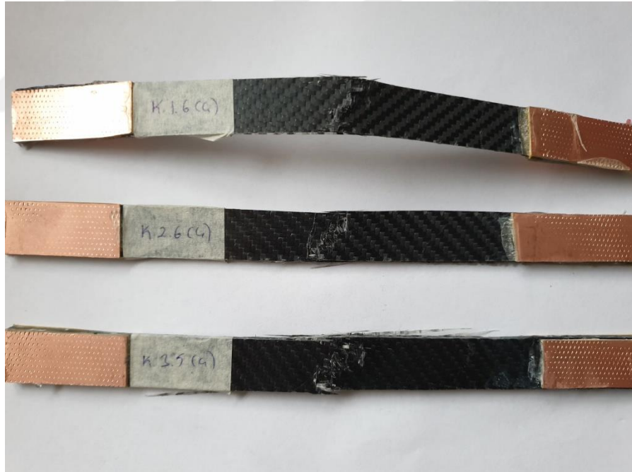
Şekil 5.11: Yüzey çatlaklı numunelerdeki deformasyon
