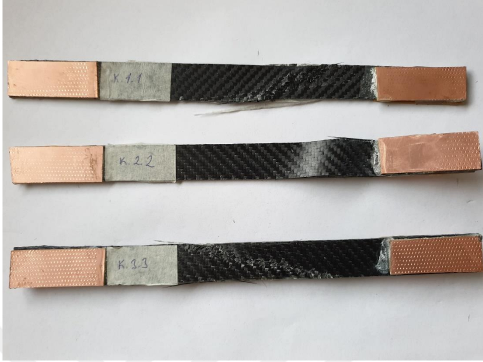
Şekil 5.10: Yüzey çatlaksız numunelerdeki deformasyon
