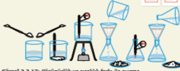
Görsel 2.2.17: Çözünürlük ve sıcaklık farkı ile ayırma
