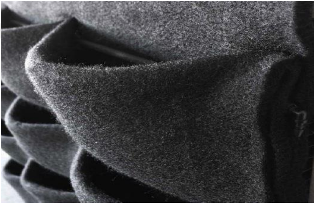
Şekil 6.4: Dikey Bahçelerde Kullanılan Yalıtım Malzemesine Örnek
