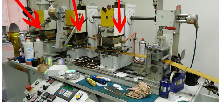
1. Sıcak baskı kalıbı 2. Sıcak baskı kalıbı Kesim bıçağı
