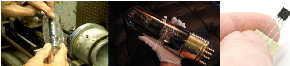
Resim 68 Sol baştan: Vakum tüp yapımı, büyük boy amplifikatörler için vakum tübü, transistör (Vakum tüpleri ve tranzistör görselleri, https://virtuabotix-virtuabotixllc.netdna-ssl.com/core/wp-content/uploads/2013/12/IMG_2990.jpg , http://cdn.head-fi.org/e/ef/500x1000px-LL-efcbfb78_KronzillaT-1610.jpeg , https://i.ytimg.com/vi/GAMRHcbE3g0/hqdefault.jpg . Erişim tarihi:02.12.2016, 13.41)
