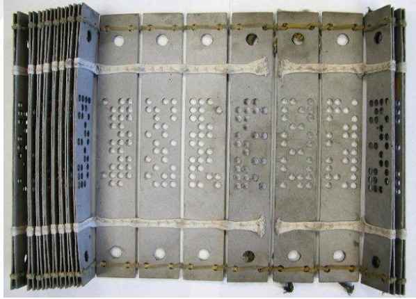
Resim 55 Jacquard Tezgahtında kullanılan metal yüzey üzerinde oluşturulmuş delikli kartlar (Jacard tezgahtı delikli kart görseli, http://homepage.divms.uiowa.edu/~jones/cards/history.html , Erişim tarihi:26.12.2016, 18.32)
