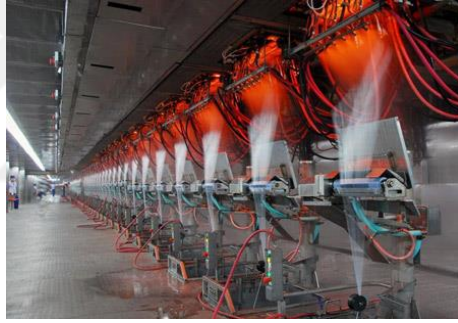
Şekil 2.21 Cam Lifi Üretimi
