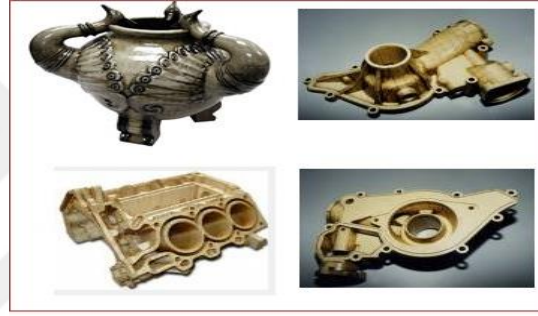
Resim 2.2: LOM sistemi ile imal edilmiş parçalar (URL28)
