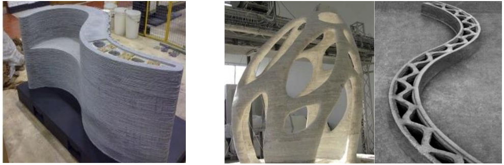
Resim 3.6: D şekilli baskı, Kontur iççiliği ve Beton baskı işleminin başarabileceği bir ürün örneği (Lim, 2012)
