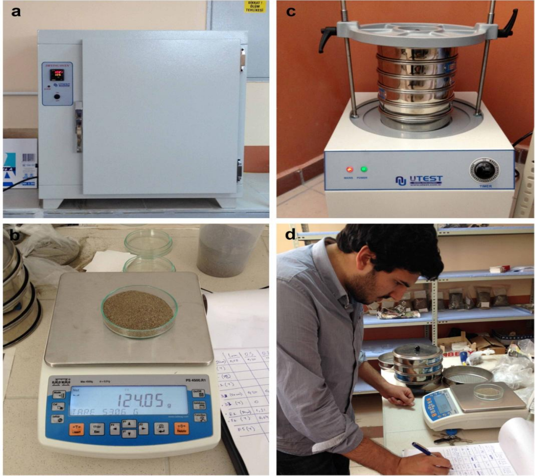
Şekil 4. Tane boyu analizlerinde kullanılan etüv (a), sallayıcı (b), hassas terazi (c) ve sonuçların not edilmesi (d)
