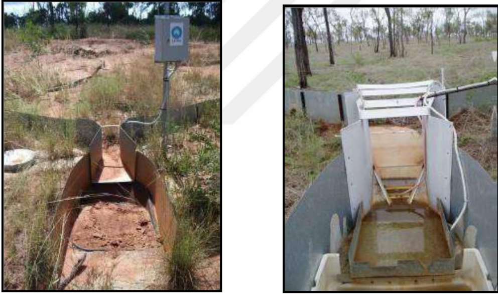
Şekil 2.8: Bitki örtüsünün yüzeysel akış üzerindeki etkisini belirlemek amacıyla kurulmuş parseller (Bartley et. al, 2006: 3321).
