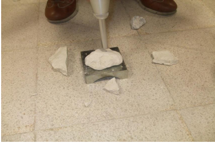
Şekil 3.26 B: Schmit çekici yardımıyla numunenin sertlik derecesinin belirlenmesi
