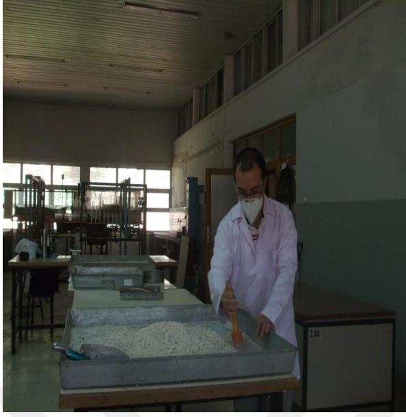
Şekil 3.22: Agregratlaşmış olan malzemenin yavaşça ezilerek normal tanelerden ayırte dilmesinin sağlanması.
