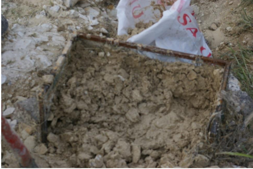
Şekil 5.24: Tuzak 1’de 3. gözlem döneminde oluşan şiddetli yağış sonrasında tuzakta biriken oldukça kötü boylanma gösteren sedimanlar: Şekilde çakıl ve daha iri boyuttaki malzemenin ince boyuttaki malzeme ile yoğrulmuş halde bulunduğu görülmektedir.
