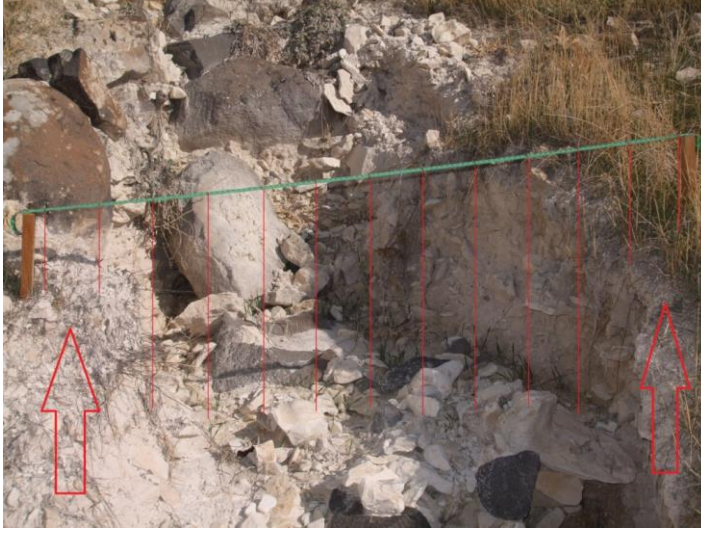
Şekil 8.9: Kanalın enine kesitini ölçme yönteminde düzenekten veri alınması
