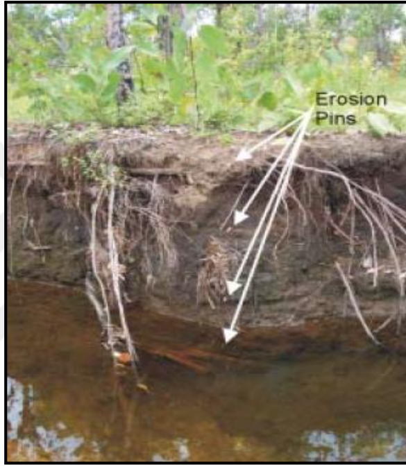
Şekil 2.2: Bank boyunca yerleştirilen erozyon çubukları (Saynor, et al., 2003: 9).
