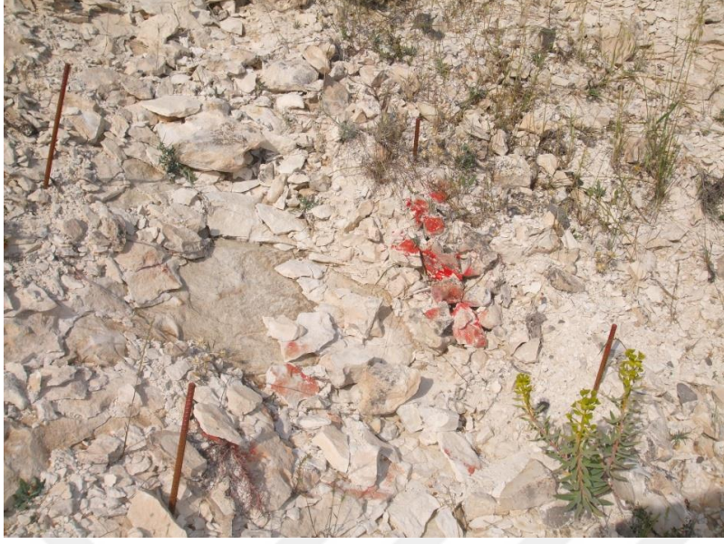
Şekil 3.11 : Güney yamaçta sınırlarının belli olması için kazıklarla belirlenilen boyalı alandan bir görünüm: Yağış sonrasında boyalı alandaki malzemenin önemli bir kısmı taşınmış ve taşınan malzemenin yerine yeni malzeme gelmiştir.
