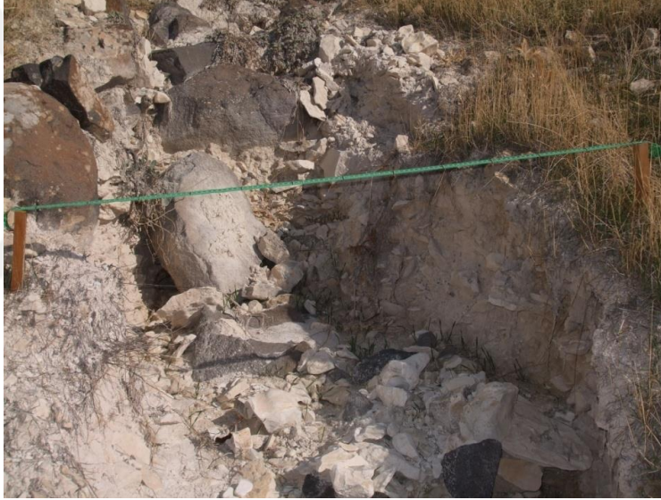
Şekil 3.19: Kanalın enine kesitini ölçme yönteminde düzeneğin kurulması.
