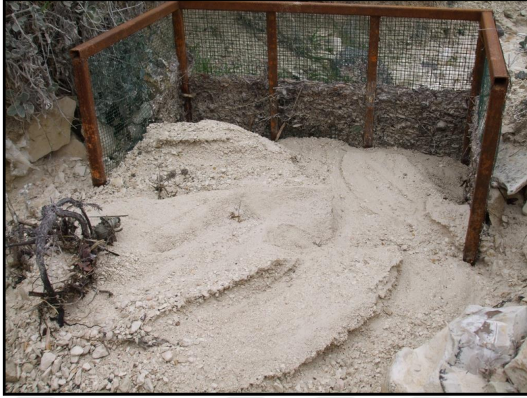
Şekil 7.11: 14. gözlem döneminde tuzak 3’te tutulan sedimandan görünüm.
