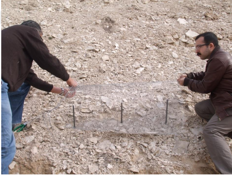
Şekil: 3.13: Ağ yönteminde kullanılan ağlardan birinin güney yamaçta araziye yerleştirilmesi.
