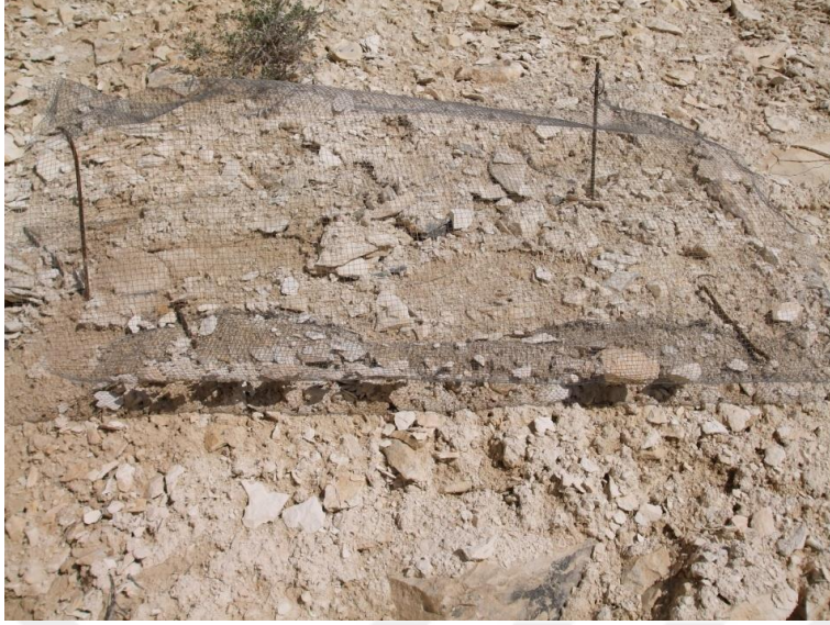
Şekil 3.14: Güney yamaçta ağ tarafından tutulan farklı boyutlardaki debriz malzeme.
