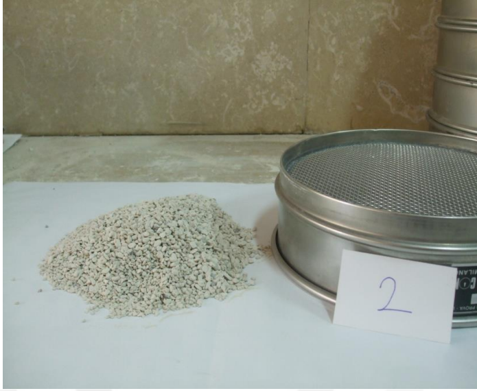
Şekil 3.25: Ağırlığı belirlenmek üzere hazırlanan 2 mm çapındaki sedimandan bir görünüm.
