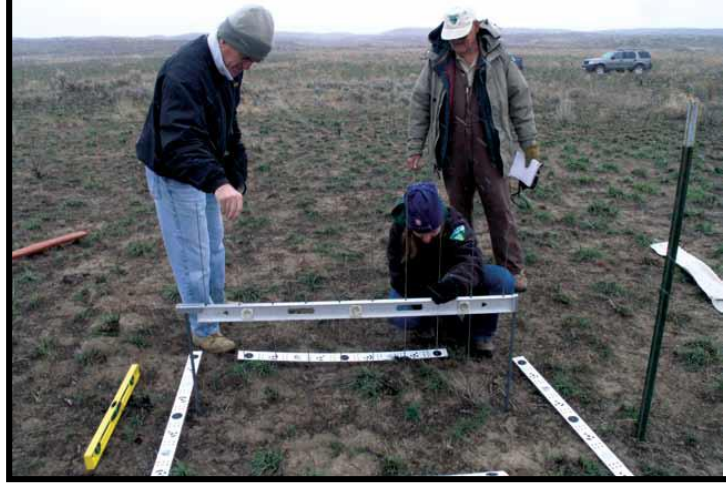
Şekil 2.6 : Erozyon köprüsünden veri alınması (Ypsilantis, 2011: 20).
