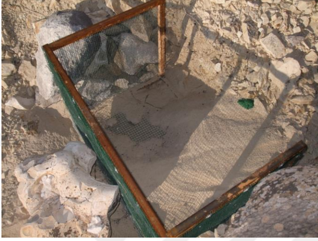
Şekil 5.8: Tuzak 2'de biriken ince sediman ve tuzak içerisinde akış gösteren suyun ince sediman üzerinde oluşturduğu dalgalı yüzey.
