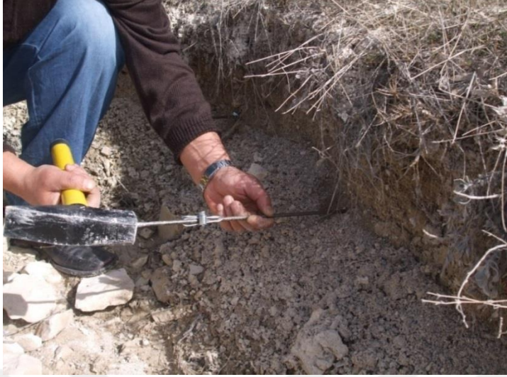
Şekil 3.16: Güney yamaçta aşağı çığırda yer alan oyuntu kenarına erozyon çubuğunun yerleştirilmesi
