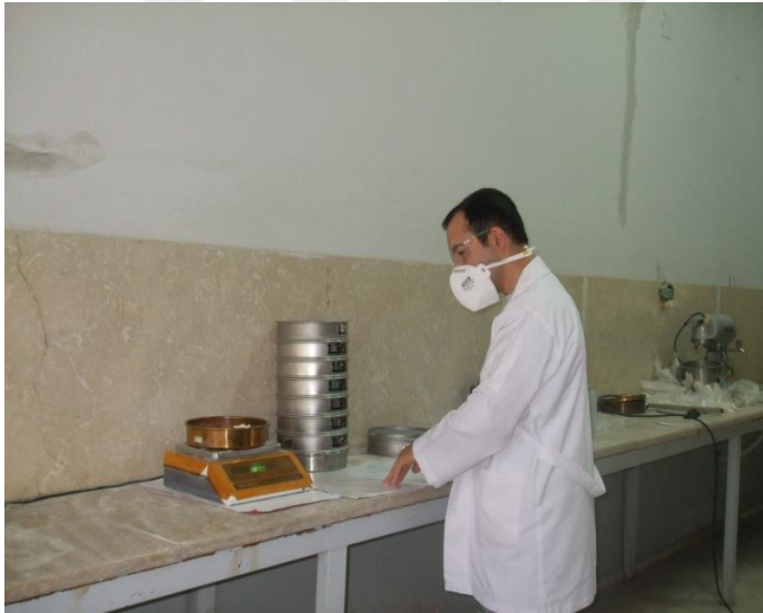
Şekil 3.24: Eleklerde biriken malzemenin elek numarası en fazla olandan en aza doğru olacak şekilde tartılması ve ağırlıklarının kaydedilmesi
