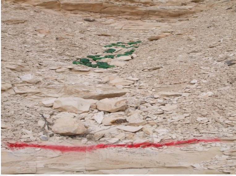
Şekil 3.5: Güney yamaca yerleştirilen yeşil boyalı taşların oyuntu içerisindeki görünümü.
