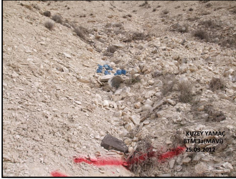
Şekil 6.1: Kuzey Yamaç 1 lokasyonuna yerleştirilen boyalı taşların ilk durumları
