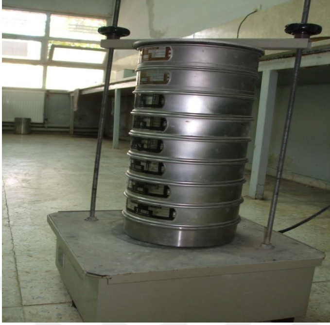
Şekil 3.23: Malzemenin tane boyu analizinin yapılmasına elverişli hale gelebilmesi için sarsma aletinin kullanılması.
