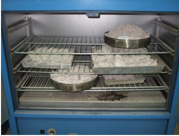
Şekil 3.20: Kuru ağırlığının belirlenebilmesi amacıyla örneklerin fırında kurutulması.
