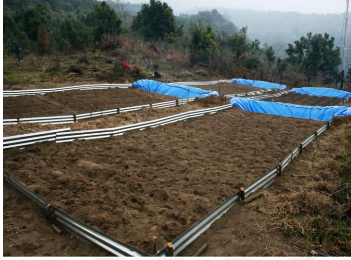
Şekil 2.10: Dikdörtgen şeklinde tesis edilen ve depolama birimi olarak çukurların kullanıldığı yüzeysel akış parsel düzeneği ( http://www.nssc.gov.bt/sustainable-land-management-project ).
