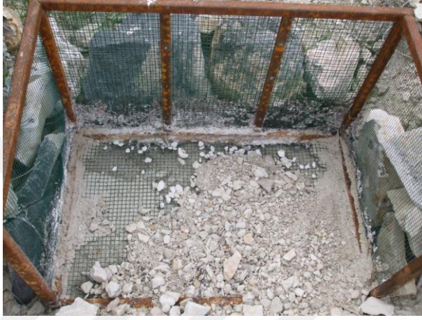
Şekil 5.28: Tuzak 3'te 11. gözlem döneminde ince sedimanın yıkanarak ortamdan uzaklaştırılması sonrasında tuzakta kalan daha kaba sediman.
