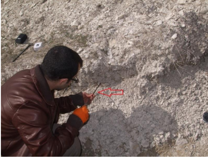
Şekil 3.15: Güney yamaçta orta çığır (bank) lokasyonuna erozyon çubuklarının yerleştirilmesi.
