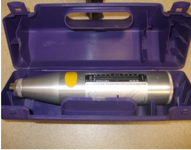
Şekil 3.26 A: Kayaç sertlik derecesinin belirlenmesi için kullanılan Schmit çekici
