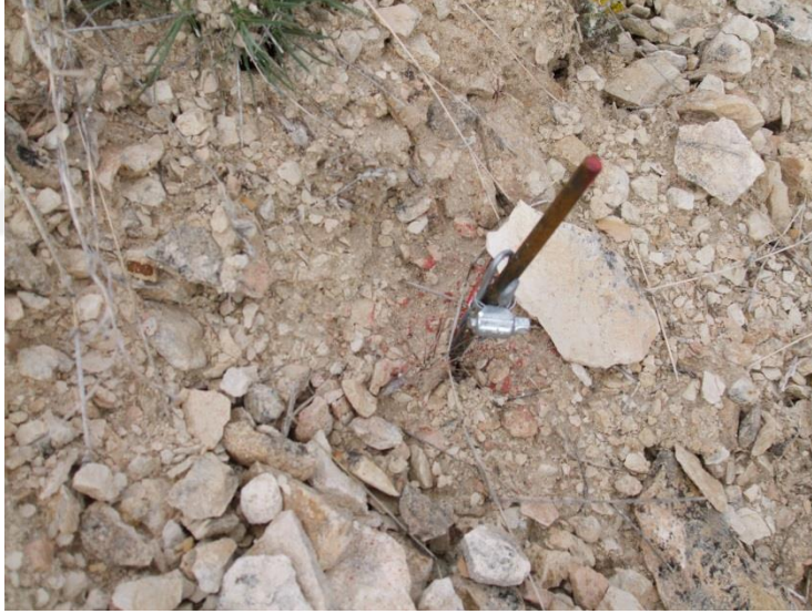
Şekil 8.8: Debris malzemesi ile kaplı yamaç boyunca yerleştirilen erozyon çubuğunun görünümü.
