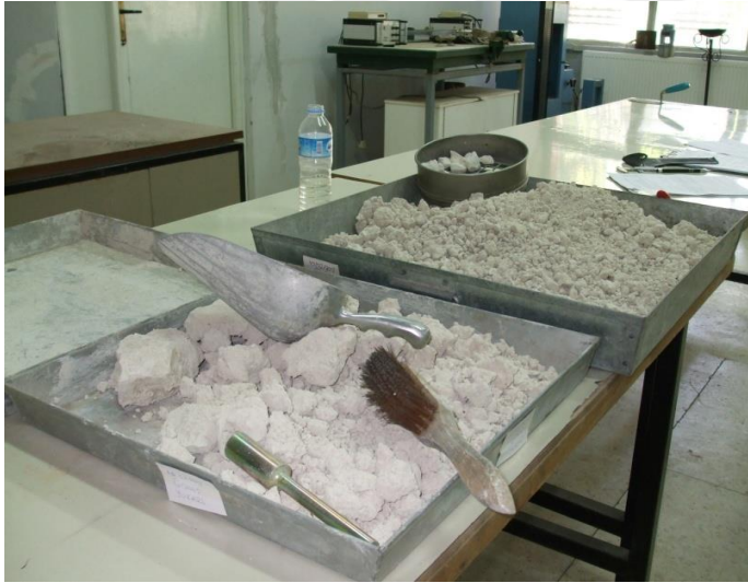
Şekil 3.21: Fırında kurutulan malzemelerin agregatlaşmış olanları ile 16 mm'den daha büyük olanlarının ayırılması amacıyla tasnif edilmesi.
