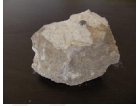
Fotoğraf 3.2: Nevşehir- Kapadokya Yöresinde Bulunan Peribacalarının Takke (a) ve Gövde Kısımlarından (b) Alınan Numuneler
