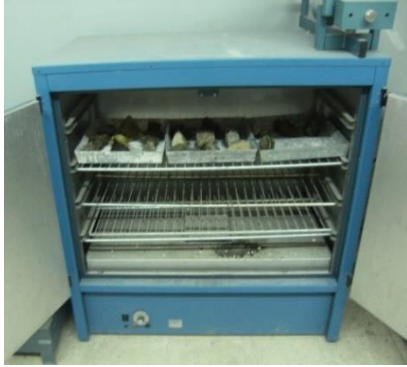
Fotoğraf 1.2: Kayaç Örneklerini Yüksek Isıda 24 Saat Kurutma İşlemi İçin Kullanılan Fırın (a), Kayaç Örneklerinin Tam Kuru Ağırlığını Bulmak İçin Yapılan İşlem (b)
