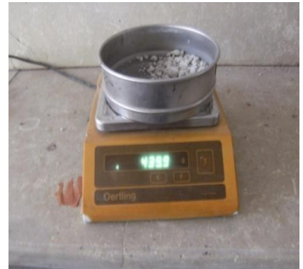
Fotoğraf 1.4: Britanya Ölçeği İle Darbe Dayanımı Testi (a), Elek Üstünde Kalan Ağırlığın Tespiti (b)
