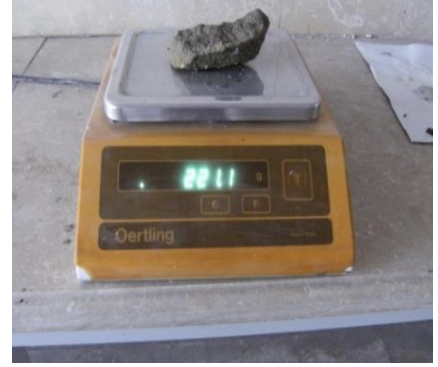
Fotoğraf 1.2: Kayaç Örneklerini Yüksek Isıda 24 Saat Kurutma İşlemi İçin Kullanılan Fırın (a), Kayaç Örneklerinin Tam Kuru Ağırlığını Bulmak İçin Yapılan İşlem (b)
