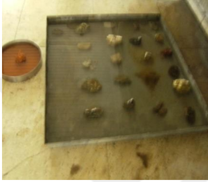
Fotoğraf 1.3: Kayaç Örneklerinin 24 Saat Suda Bekletilmesi (a) ve Fön Makinesi İle Kurutulması (b)
