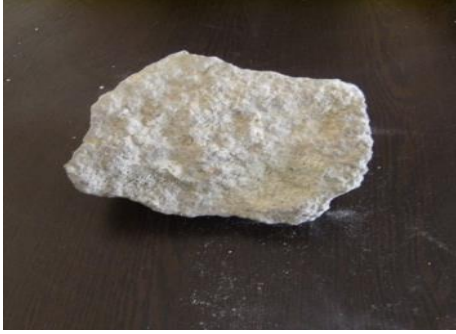
Fotoğraf 3.11: Soma Yöresinde Bulunan Peribacalarının Takke (a) ve Gövde Kısımlarından (b) Alınan Numuneler
