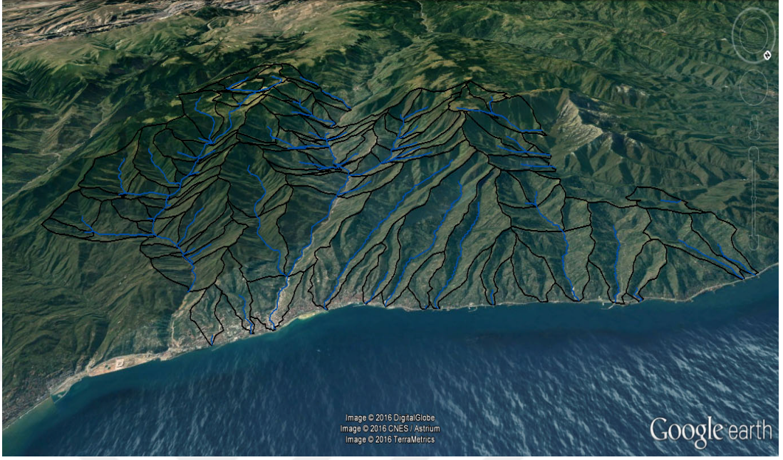
Foto 10: Hidrolojik analizler sonucunda elde edilen akarsu ve alt havza sınırlarının uydu görüntüsüne uygulanması
