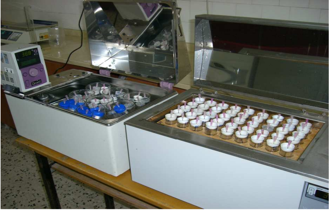
Resim 2: İn vitro sindirim denemesinde kullanılan inkubasyon düzeneği.
