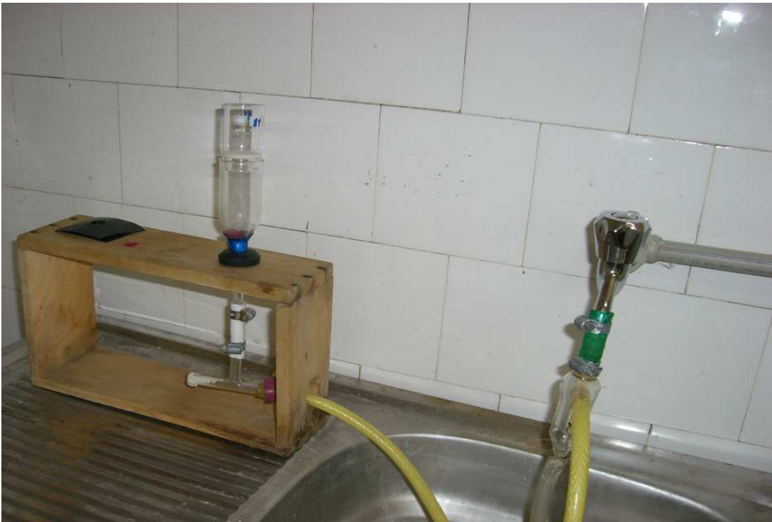
Resim 3: İn vitro sindirim denemesinde kullanılan süzme düzeneği.
