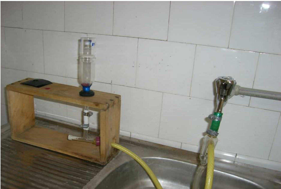
Resim 3: İn vitro sindirim denemesinde kullanılan süzme düzeneği.
