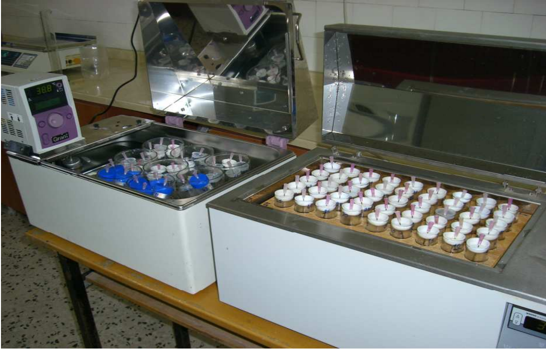
Resim 2: İn vitro sindirim denemesinde kullanılan inkubasyon düzeneği.
