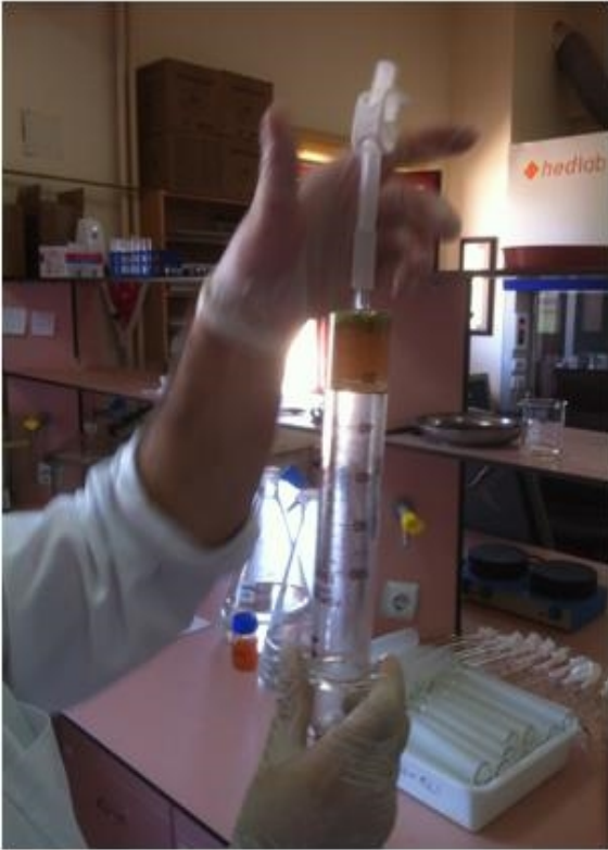
Resim 5. Şırınga pistonlarının şırıngada hava kalmayacak şekilde konumlandırılmaları ve su banyosunda inkubasyonun başlatılması.
