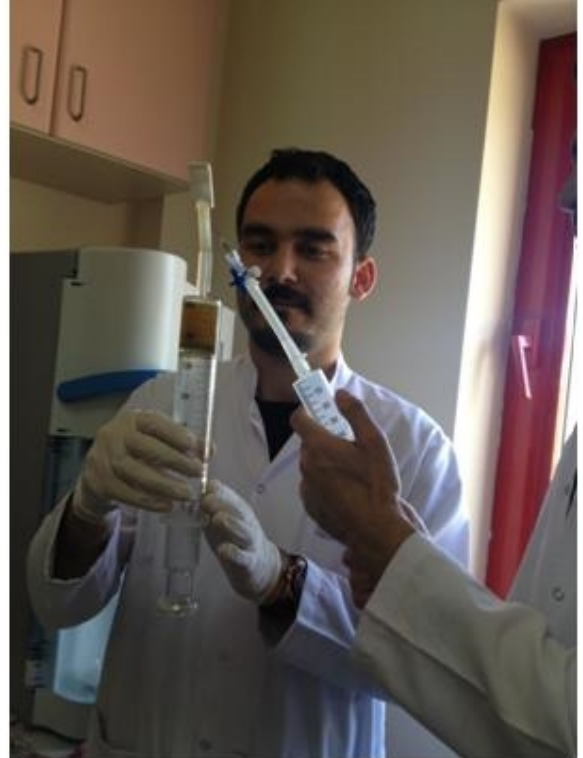
Resim 7. İnkubasyonun 24. saatinde şırıngalardan üç yollu enjektör yardımı ile gazın alınması.
