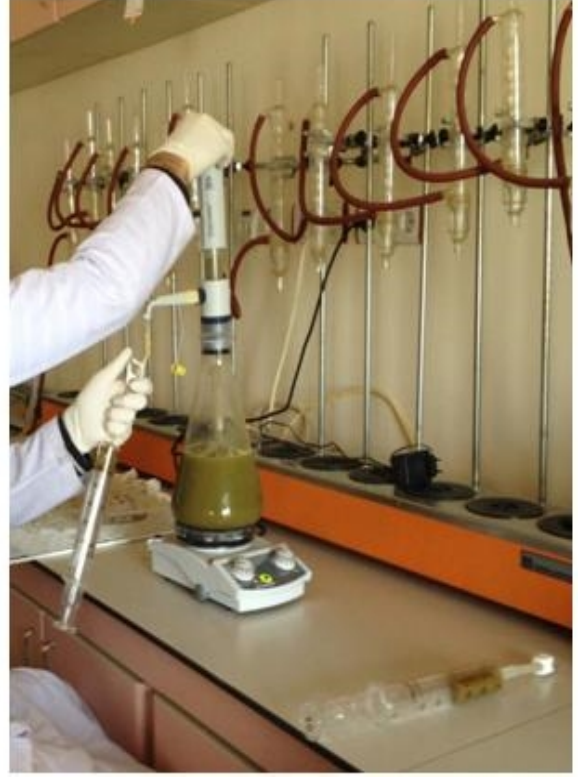
Resim 4. Suni tükürük-rumen sıvısı karışımına CO 2 gazı verilmesi ve şırıngalara konması.
