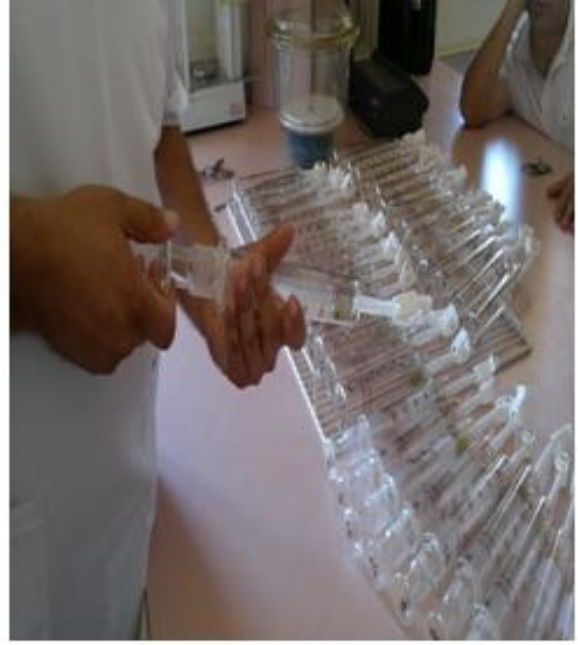
Resim 2. In vitro gaz üretim tekniğinde yemlerin tartımı ve şırıngaların vazelinlenmesi.
