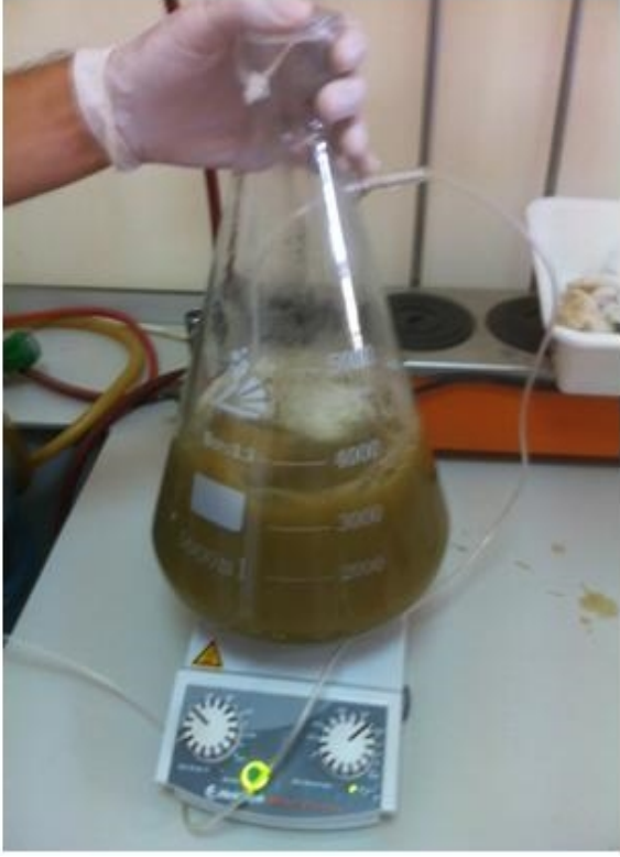
Resim 4. Suni tükürük-rumen sıvısı karışımına CO 2 gazı verilmesi ve şırıngalara konması.
