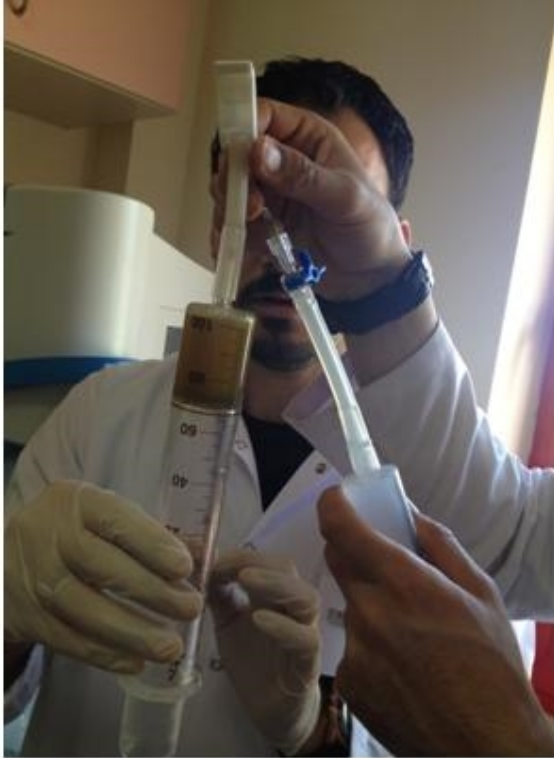
Resim 7. İnkubasyonun 24. saatinde şırıngalardan üç yollu enjektör yardımı ile gazın alınması.
