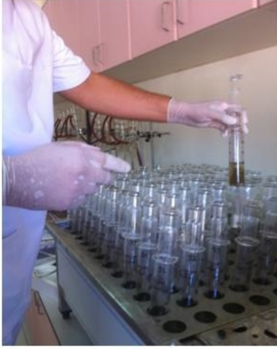
Resim 6. Şırıngaların periyodik olarak bilekten çalkalanılarak karıştırılması.
