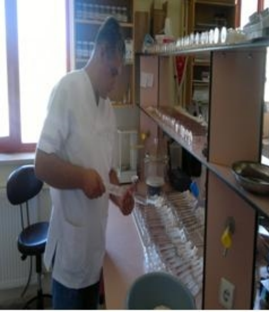
Resim 2. In vitro gaz üretim tekniğinde yemlerin tartımı ve şırıngaların vazelinlenmesi.
