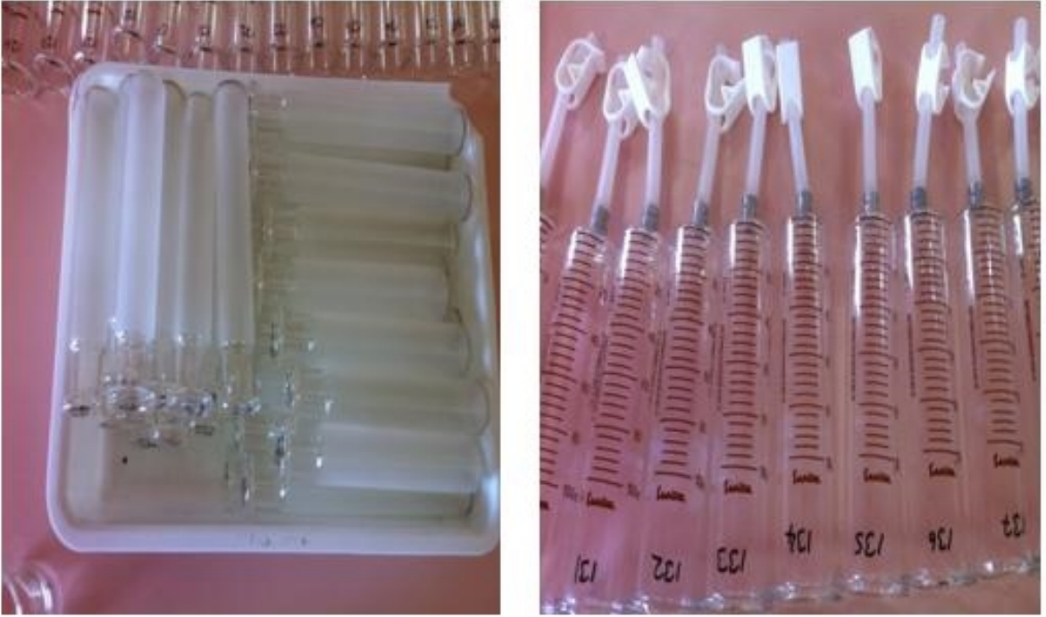
Resim 1. In vitro gaz üretim tekniğinde kullanılan 200 ml ölçekli özel şırıngalar.
