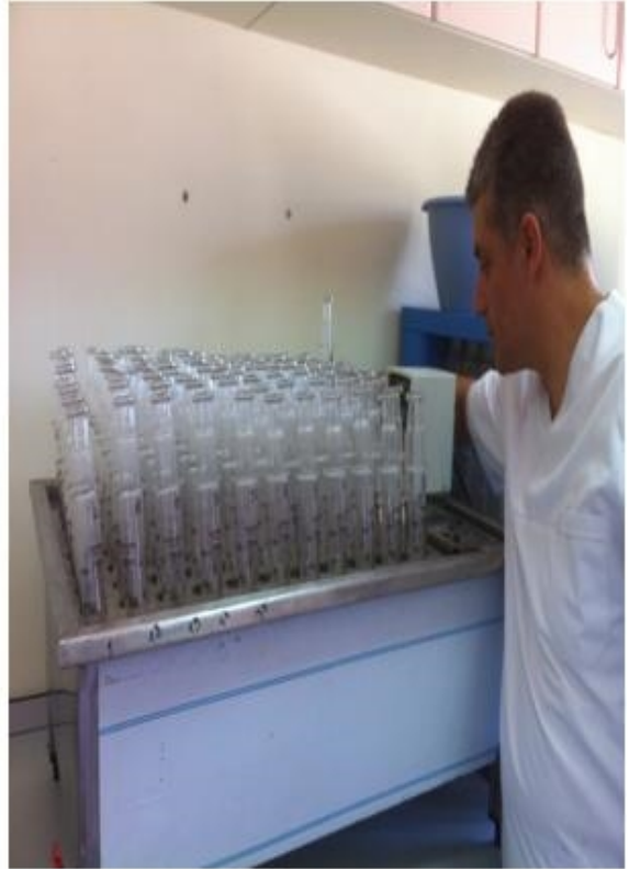
Resim 5. Şırınga pistonlarının şırıngada hava kalmayacak şekilde konumlandırılmaları ve su banyosunda inkubasyonun başlatılması.
