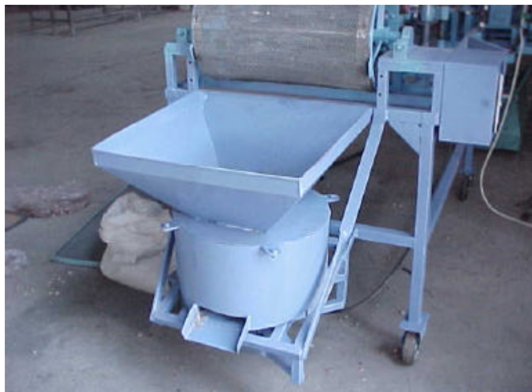
Sekil 4.7. Çelik bant ve çarpma etkisinin olusturulduđu sistem
