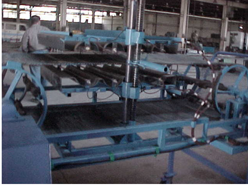
Sekil 3.3. Isıtma çubuklarına yükseltip-alçaltılmasını sağlayan ayarlı kol
