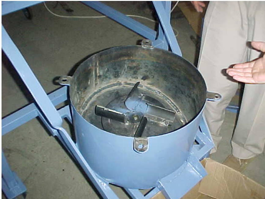
Sekil 3.4. Çarpma ünitesi içerisinde bulunan disk yüzeyindeki çarpma diski
