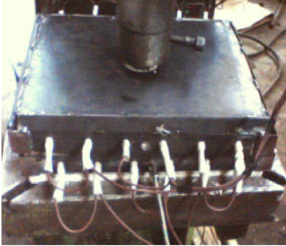
Şekil 4.22. Kalıbın monte edilmiş hali
