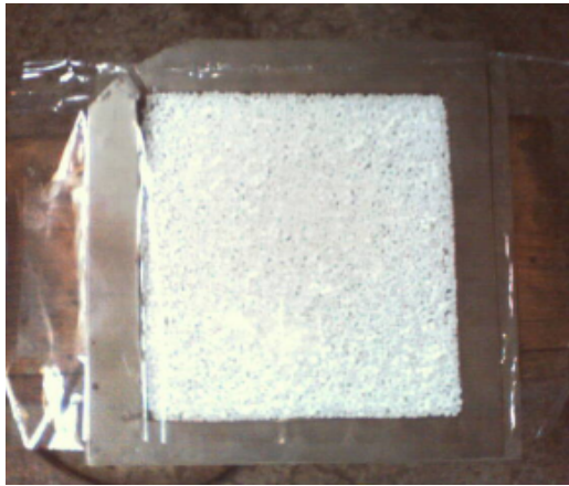
Şekil 4.29. Granüllerin saç kalıplarda dizilişi
