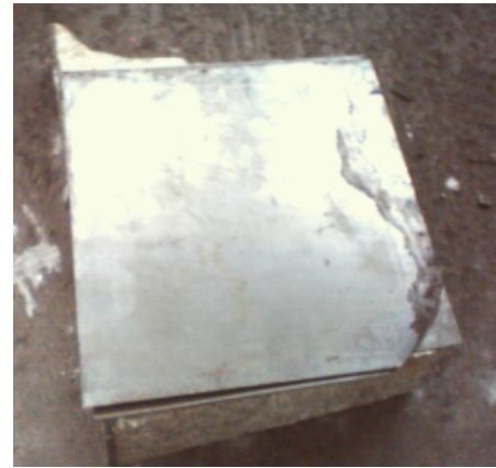
Şekil 4.30. Preslemeye hazır polimer malzeme numunesi
