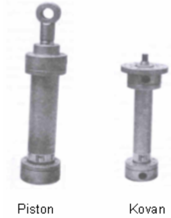
Şekil 4.8. Hidrolik sistemlerde kullanılan piston ve kovan resmi
