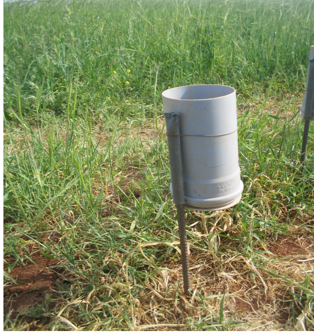
Şekil 3.5. Su toplama kabının tarla uygulamasındaki görünümü
