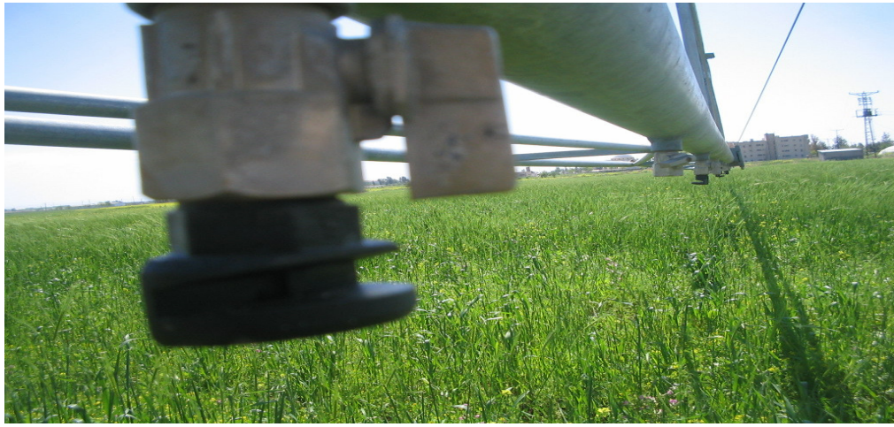
Şekil 3.3. Yağmurlama başlıklarının sulayıcı kol üzerinde görünüşü
