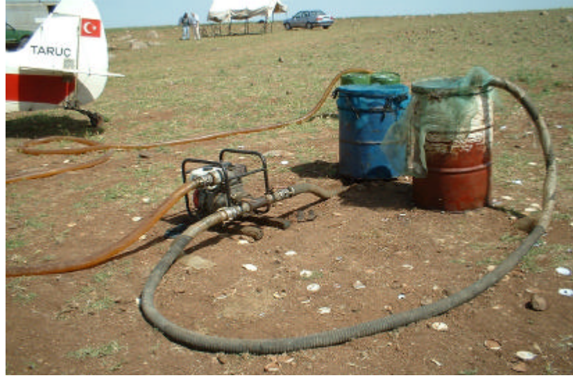
Şekil 3.11 Uçağın ilaç deposunun doldurulma çalışması
