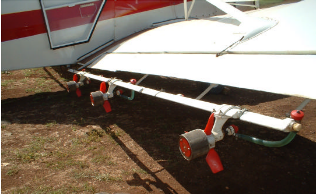
Sekil 3.1. AU 5000-2 atomizörlerinin püskürtme çubuğu üzerinde görüntümü
