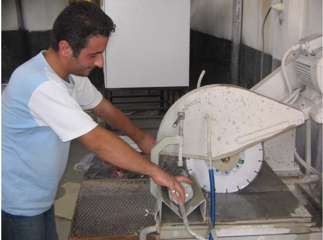
Şekil 3.9. Karot başlarının elmas testere yardımıyla kesilmesi
