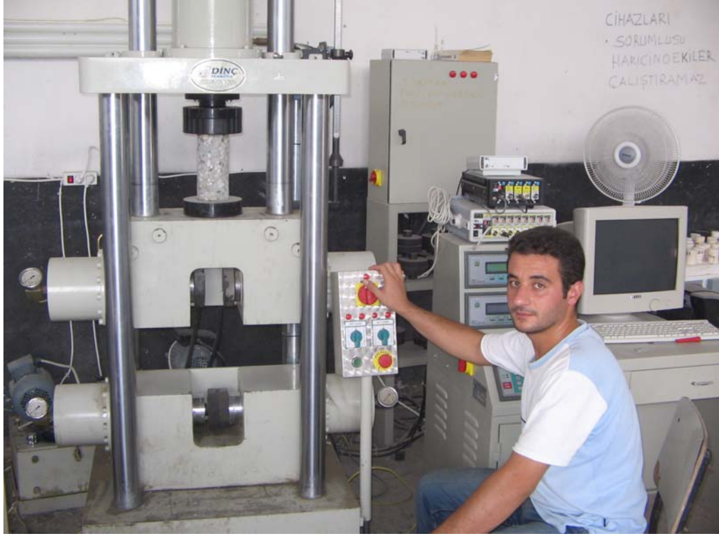
Şekil 3.10. 80 ton kapasiteli servo kontrollü pres ve beton karot
