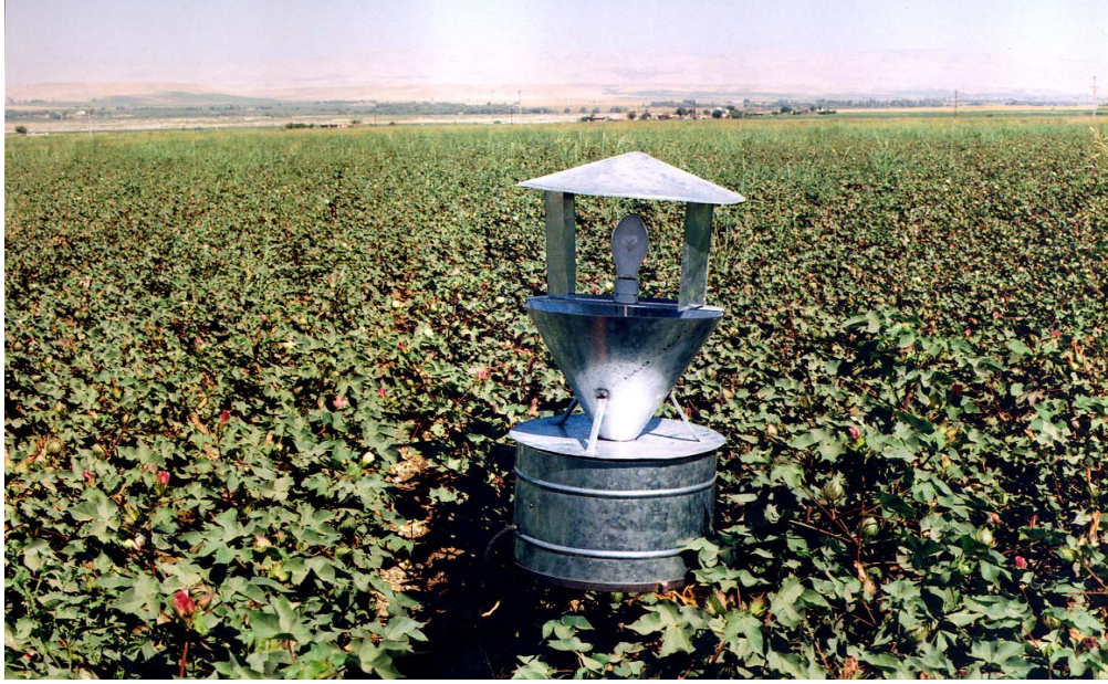
Şekil 3.2. Dikenlikurt popülasyon takibinde kullanılan Robinson tipi ışık tuzağı
