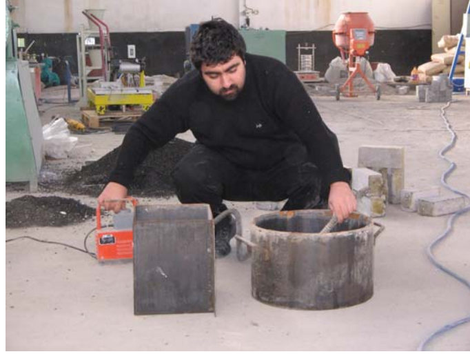
Şekil 3.5. Beton karışımının kalıplara yerleştirilip, sıkıştırılması
