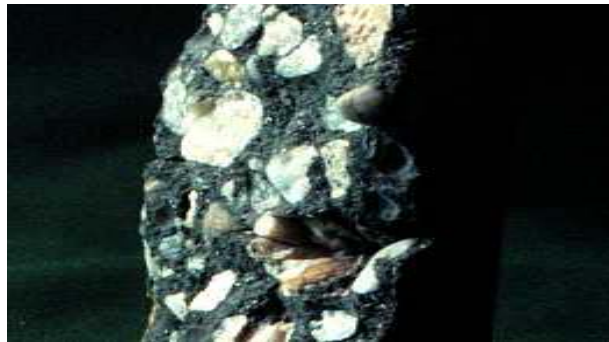
Şekil 1.5. Silis dumanı ihtiva eden bir beton numunesinin test edilmesi
