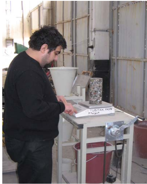
Şekil 3.12. Arşimet terazisinde birim ağırlıkların bulunması
