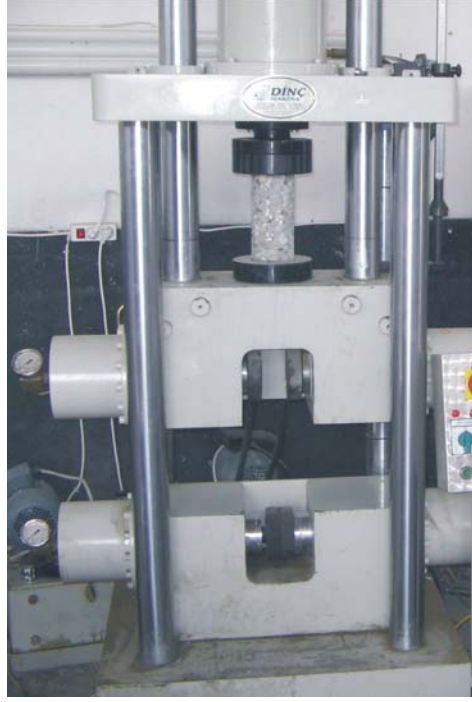
Şekil 3.13. 80 ton kapasiteli servo kontrollü pres ve beton karot
