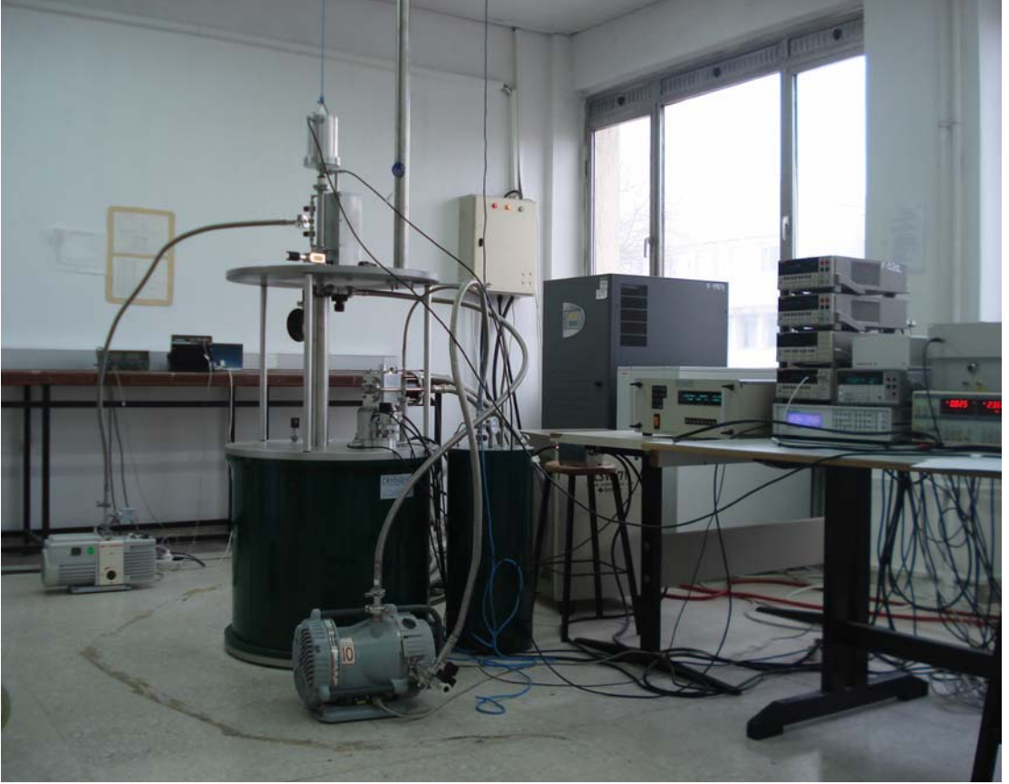
Şekil 3.12. Vibrating Sample Magnetometer (VSM) sisteminin fotoğrafı
