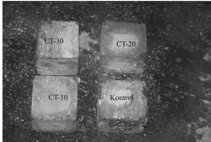
Şekil 4.4. 600 C sıcaklıktaki numune 20 C su ile soğutulduktan sonra
