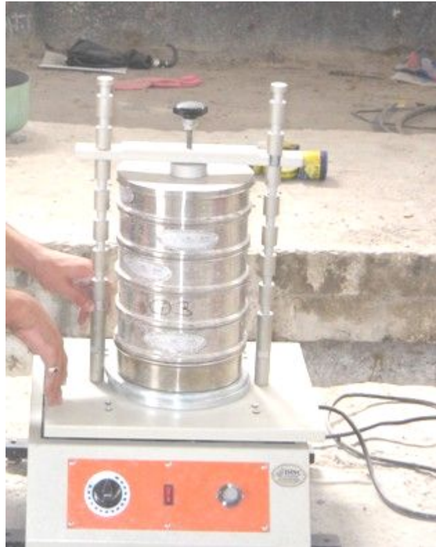
Şekil 3.2. Cam tozu, iri ve ince agregaların elek analizinin yapılması
