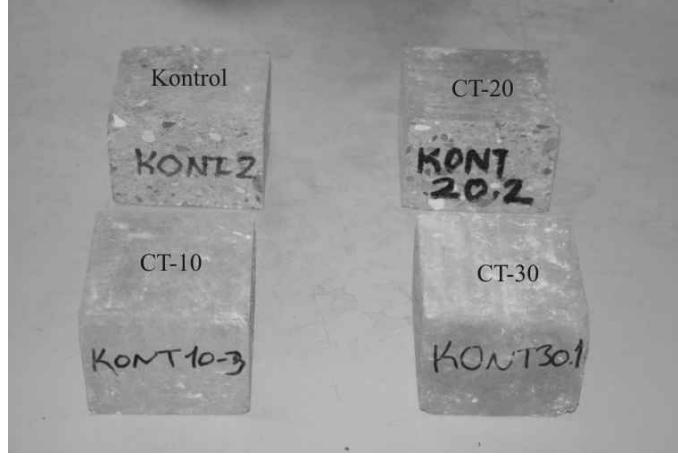
Şekil 4.2. 600 C sıcaklığa maruz kalmadan önce numune durumları
