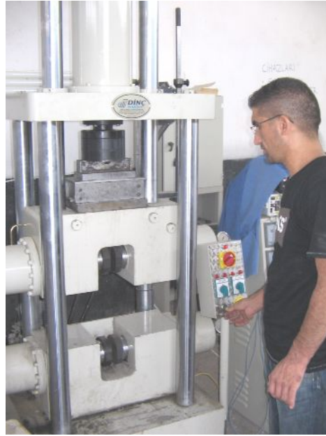
Şekil 3.4. Taze karışımın çelik kalıp içerisinde sıkıştırılması
