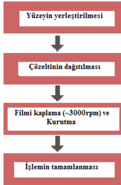
Şekil 3.8. Spin kaplama aşamalarının şematik gösterimi
