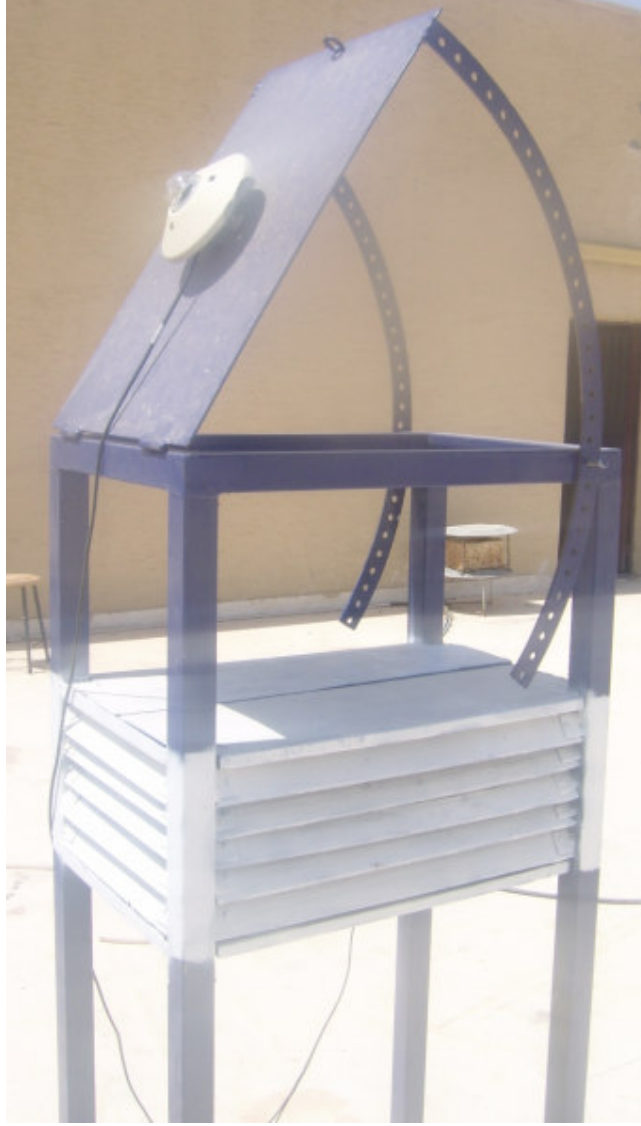
Şekil 3.7. Eğimi ayarlanabilen platform ve CM11 piranometre
