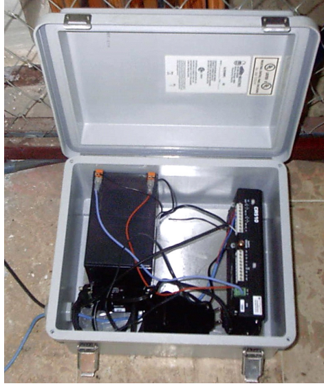
Şekil 3.4. Fiber muhafazalı veri kaydedicisi (datalogger) ve bataryası
