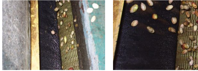
Şekil 4.4. Yumuşak kabuğu soyulmamış taneleri geri çeviren ünite
