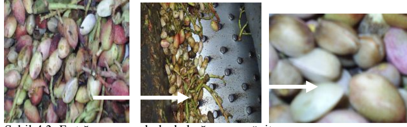
Şekil 4.3. Fıstığın yumuşak dış kabuğu soyan ünite
