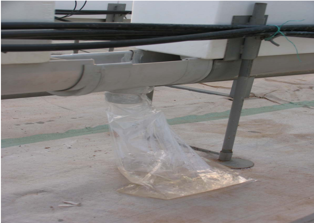
Şekil.4.9. Oluk sonuna bağlanan su toplama poşetleri
