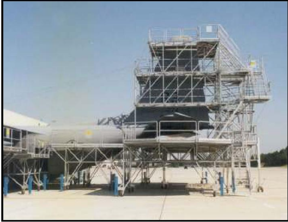
Şekil 3.8. Uzay kafes sistem uçak bakım iskelesi
