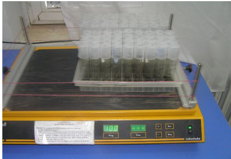
Şekil 3.8. İyon akışı için örneklerin çalkalayıcı aletindeki genel görünümü
