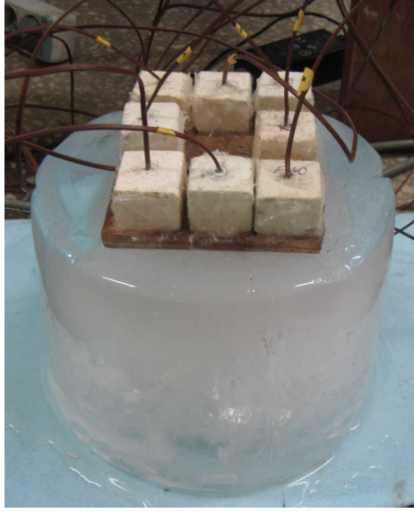
Şekil 3.22. Buz kütlesi üzerine yerleştirilmiş test numuneleri (sağ resim) ve deneyler sırasında sıcaklık ölçüm aparatının görünümü (soldaki resim)
