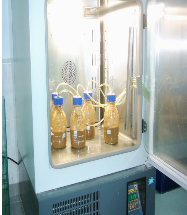
Şekil 3.2. Biyogaz reaktörlerinin inkübatöre yerleştirilmesi
