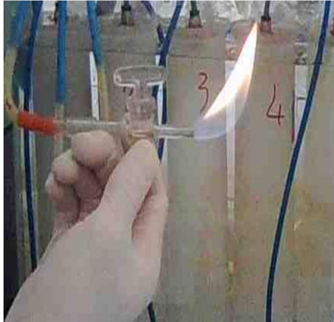
Şekil 3.3. Toplama kabininde toplanan gazda metan varlığı Metan detektörü ile tespit edildikten sonra biyogaz kontrollü bir şekilde yakılarak biyogaz varlığı ortaya konulmuştur.
